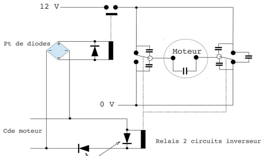
Diodes à cabler selon sens de rotation et contact repos du relais
