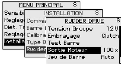
La *Sortie moteur* (affichée en pourcentage) correspond à la puissance maximum nécessaire pour obtenir la vitesse adéquate de déplacement du vérin en mode auto. (La vitesse maxi est obtenue en mode NFU). Ce réglage vous permettra d'ajuster la vitesse en la personnalisant par rapport au réglage automatique par défaut.
