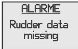
Si l'AP 24 est connecté à d'autres appareils SimNet, toute alarme dans le système s'affichera sur l'unité de contrôle.
