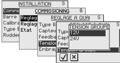
La tension de commande de l'embrayage ou de la vanne by-pass est la même que celle sélectionnée pour l'unité de puissance. Il n'est pas possible de sélectionner une tension supérieure à la tension d'entrée.
