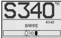
L'angle de barre une fois activé affichera 10° en alternance entre Bâbord et Tribord pour indiquer que le point zéro doit être réglé.
