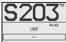
Quand le pilote automatique fonctionne sous Virtual Rudder Feedback (VRF), aucune information n'apparaît dans la fenêtre angle de barre en mode standby
