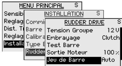
La fonction est réglable manuellement si le réglage automatique ne fonctionne pas de manière satisfaisante en raison d'une trop grande inertie de la barre et d'un système de barre trop souple.
