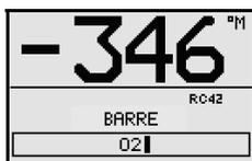
Lorsque le pilote est configuré en EVC, vous pouvez prendre le contrôle manuel de la direction avec la barre quelque soit le mode du pilote. Le pilote se mettra en mode standby. Le "S" est remplacé sur l'affichage par une ligne indiquant que la gouverne se fait à partir de la barre. Voir page 117.
