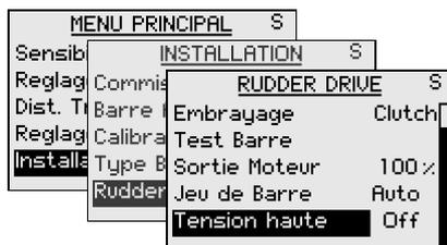
Lorsque vous définissez un niveau de tension, la sortie proportionnelle sera désactivée et les commandes moteur seront similaires au fonctionnement des électrovannes (on-off). La tension peut être ajustée par pas de 1V. Si elle est réglée à la tension maximale (12V / 24V), il sera lu *Sol*. (Solénoïdes).
