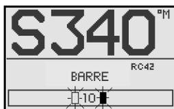
Si votre pilote Simrad comprend une unité de puissance MSD50, l'angle de barre affiché à la mise en marche du pilote automatique alterne entre 10° Bâbord et 10° Tribord pour indiquer qu'il faut régler le point zéro de la barre.
