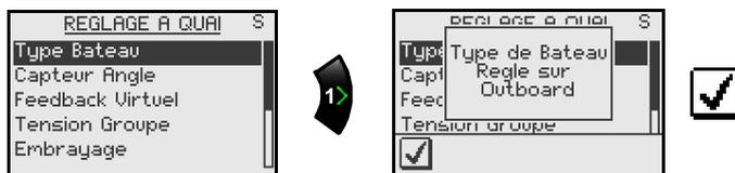
Quand le pilote est configuré pour un Feedback Virtuel le *Type de bateau* est automatiquement réglé sur **Outboard (Hors-bord)**.
