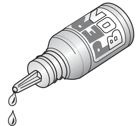
Colle de blocage.
