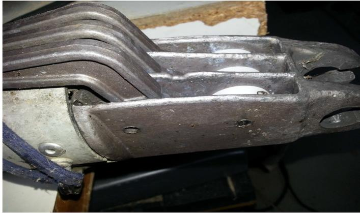
le plus simple est de retirer les bloqueurs en chassant l'axe avec un chasse goupilles (repérer le coté qui comporte des fines cannelures ... en principe à l'opposé du coté qui comporte des traces de frappes antérieures)
