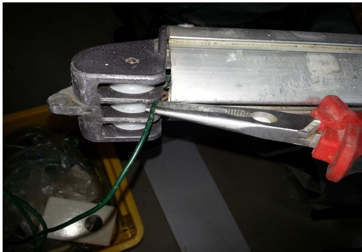
La capture (avant les réas) se fait avec un fil de fer en crochet aidé d'une pince d'électricien à bec long
