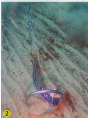
La Manson s'enfouit de façon satisfaisante (2) et travaille bien (3 et 4). Au final, elle fait cependant moins bien que la Rock ou la Rocna qui coûtent sensiblement le même prix (si on considère le modèle en acier galvanisé). Notez la verge ajourée, censée faciliter le décrochage de l'ancre sur des fonds rocheux.
