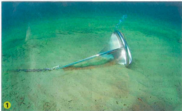
La géométrie très aboutie de la Rock se traduit par de bons résultats. Sur la courbe, on remarque notamment qu'elle ne commence à labourer que vers une tonne de traction.
