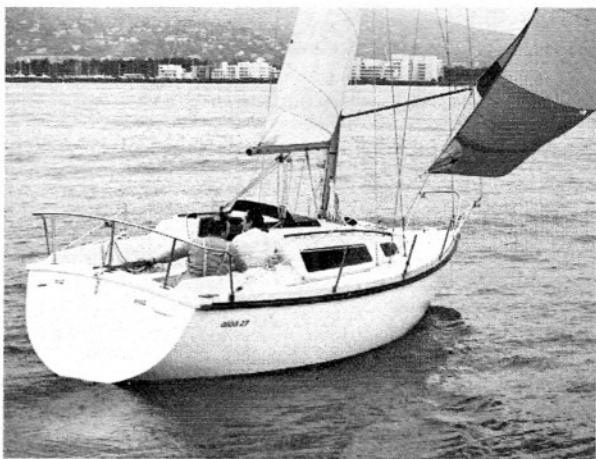
Avec deux équipiers dans le cockpit, le bas du tableau arrière commence à tremper dans l'eau. La coque aurait demandé à bénéficier d'un allongement de sa partie arrière.
