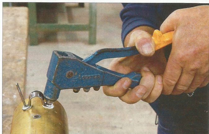
▲ Eric préserré le premier Pop en fermant deux fois les pinces de la riveteuse (en règle générale, il faut trois « coups » pour casser le clou).
