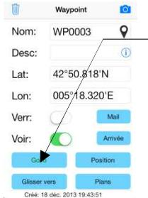
Le bouton « **GoTo** » marque par une ligne bleue continue la navigation depuis la situation du bateau (ici à l'intérieur des terres...) jusqu'au WP sélectionné. Dans le bandeau bleu s'affichent la distance, le cap, l'écart de route XTE, et le TTG
