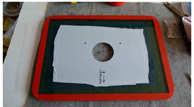
Pour tracer la partie intérieure, il faut d'abord centrer le plexi dans le cadre au moyen de cales d'épaisseur, ( des allumettes, ça le fait ) et bloquer l'ensemble pour le retourner et tracer.
