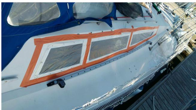
Dans la foulée, on démonte aussi les ouvrants des capots de pont. Bien entendu, les axes ne veulent pas sortir et on les achève à la perceuse. On pose les contre-plaqués préparés pour. J'ai quand même très froid aux mains, mais on a bien avancé.
