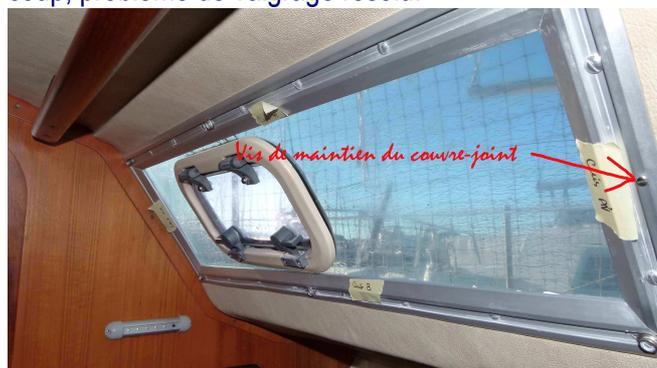
Cela fait, une personne à l'intérieur avec le tournevis, l'autre à l'extérieur avec la visseuse. Hormis trois vis qu'il faudra finir à la perceuse, tout se passe plutôt bien, les hublots ne restent pas collés et sont démontés en une demi-heure sans se casser.
