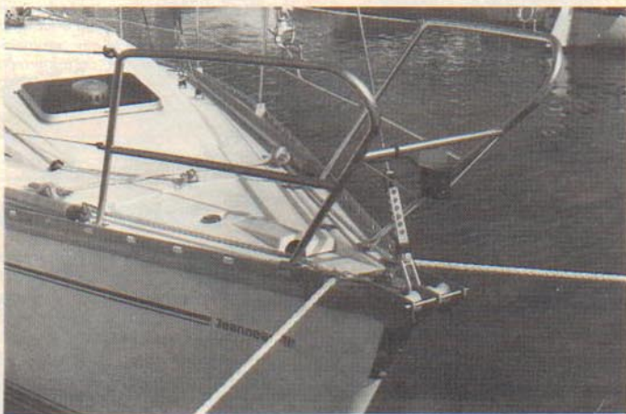
Le balcon ouvert à la suédoise facilite l'accès par l'étrave.
