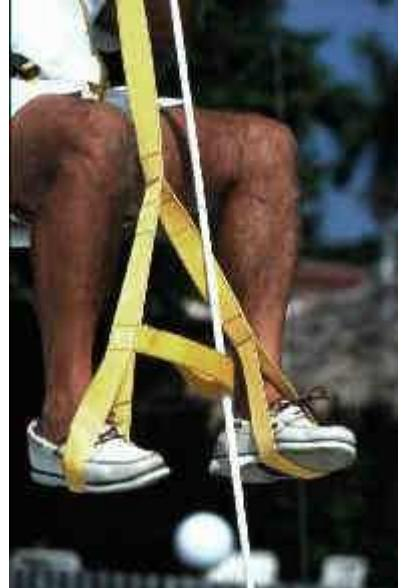
Le Topclimber est le seul système pour monter au mat qui non seulement permet de monter au mat en se servant principalement des jambes, seul, mais aussi de rester confortablement assis, longtemps, tout en ayant les mains libres pour travailler. Et aussi de pouvoir accéder au dessus du mat sans sortir de la chaise.
