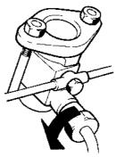
115. Dévisser les écrous des tuyaux de refoulement des injecteurs. Pousser la commande d'arrêt et mettre la commande de régime à la position plein gaz. Enfoncer le dispositif de démarrage à froid sur MD11. Faire tourner le moteur avec le démarreur jusqu'à ce que le carburant arrive jusqu'aux tuyaux de refoulement. Serrer les écrous des tuyaux de refoulement et mettre le moteur en marche.
