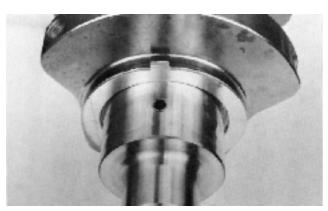
67. MD11: Lubrifier les deux rondelles de roulement axial et monter l'une d'elles sur le vilebrequin, le côté plan tourné vers le palier arrière (du côté des pignons de distribution). L'autre rondelle sera montée suivant le paragraphe 74.
