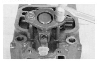
**26.** Démonter les injecteurs et monter des capuchons protecteurs.
