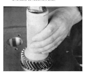
**75.** Monter la clavette pour le pignon d'entraînement du vilebrequin. Chauffer le pignon jusqu'à environ 100°C et le monter sur le vilebrequin. Vérifier que la rondelle axiale intérieure n'a pas bougé.
