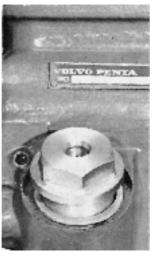
Reposer le tuyau d'huile pour la culbuterie. Reposer le mano-contact d'huile et un filtre à huile neuf. MD11: Reposer la crépine à huile. ATTENTION! Passer du Permatex sur la surface d'étanchéité de la crépine ainsi que dans le filetage et bien serrer le couvercle (à la clé dynamométrique) de façon à ce que l'air ne puisse pas pénétrer et abîmer le graissage. ATTENTION! Ne pas oublier la garniture.
