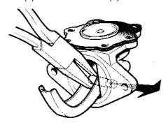
56. Démonter l'axe du culbuteur à l'aide d'une pince pointue. Enlever le culbuteur et la membrane. Remplacer les pièces qui sont inclues dans le kit de réparation et remonter la pompe.
