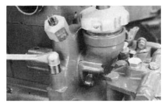
102. Monter le reniflard et éventuellement le démarreur manuel. ATTENTION! Après le montage du démarreur manuel contrôler le jeu entre le pignon d'entraînement du starter et celui de l'arbre à cames (sur MD17 ce contrôle se fait par l'ouverture sur le démarreur manuel). S'il n'y a pas de jeu augmenter le nombre de joints sous le démarreur manuel de façon à ce qu'un jeu appréciable soit obtenu.
