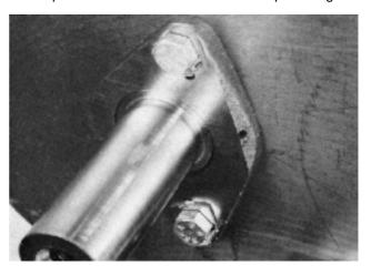
76. Monter l'arbre à cames, veiller à ce que l'arbre de la pompe à huile vienne bien dans la rainure correspondante dans l'arbre à cames. Verrouiller les vis avec les arrêtoirs. MD17: Veiller au positionnement du canal d'huile.
