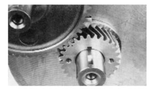
77. Monter la clavette sur le pignon d'entraînement de l'arbre à cames. Chauffer le pignon jusqu'à une température d'environ 100°C et le monter de façon à ce que les repères coïncident. Monter la clavette pour la came.
