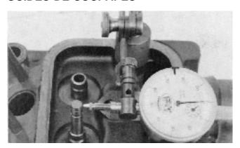
29. Contrôler l'usure des guides de soupapes en plaçant une soupape neuve dans le guide et en mesurant ensuite le jeu à l'aide d'un comparateur. Remplacer les guides si nécessaire.
