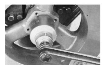
**72.** Monter la clavette et le volant (le cône devra être absolument propre), couple de serrage: 500 Nm (50 m.kg). Verrouiller l'écrou avec l'arrêtoir.
