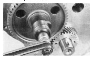
78. Monter la came et la vis/écrou à filetage à gauche sur l'arbre à cames. Couple de serrage 70 Nm (7 m.kg) pour MD11 et 320 Nm (32 m.kg) pour MD17. Contrôler le jeu axial qui doit être de 0,05 à 0,15 mm.
