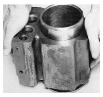
**85.** Poser la chemise avec la collerette sur un support et placer le cylindre sur la chemise. Enfoncer ensuite le cylindre à la main jusqu'à ce que la chemise touche le fond contre l'épaulement du cylindre. Vérifier que les joints d'étanchéité n'ont pas bougé de place.
