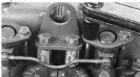
108. Remplacer le filtre à carburant. Monter les injecteurs et les serrer au couple de 20 Nm (2 m.kg). Monter tous les tuyaux de carburant et les œillets de levage.
