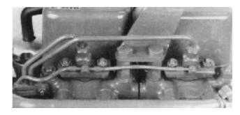
**2B.** La figure montre un nouveau modèle d'injecteurs sur les moteurs MD11 à partir du No 50989 et MD17 16622.
