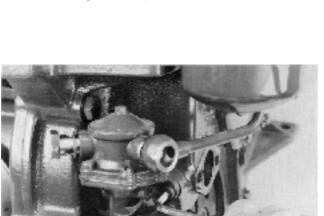
11. Déposer la pompe d'injection, la pompe à eau de mer, la pompe d'alimentation et le filtre à carburant. Les moteurs D possèdent un conduit de retour de fuites d'huile branché au raccord d'entrée (se référer à la page 27).
