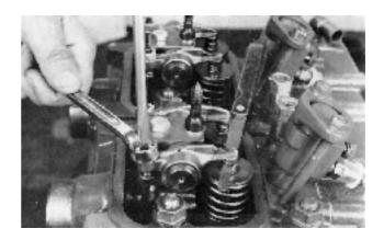
Jeu aux soupapes (moteurs chaud) admission: 0,30 mm échappement: 0,35 mm
