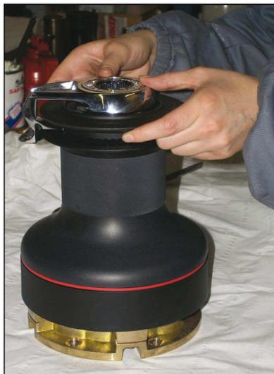
Pour les modèles supérieurs à la taille 8, dévissez les vis qui maintiennent la base du winch (photo de droite) et enlevez le corps de boîte. A ce stade, vous pouvez retirer les engrenages et les roulements facilement sans l'utilisation d'outils. Retirez également les cliquets et ressorts des pignons.
