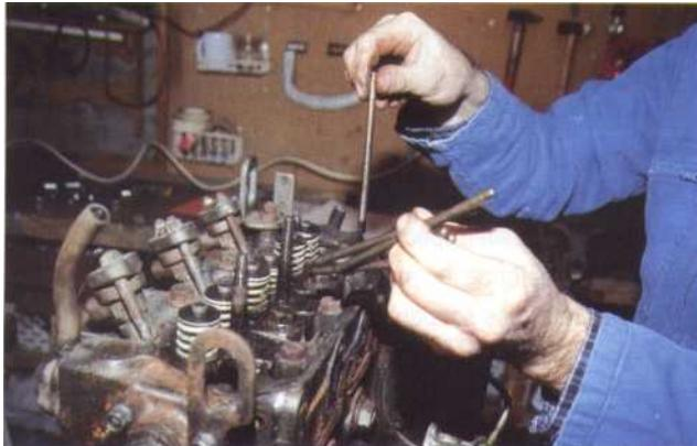
7 Sur les moteurs Yanmar, n'oubliez pas de récupérer les butées de queue de soupapes.
