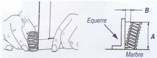
• Contrôlez aussi l'inclinaison ou l'assise du ressort. Celui-ci, lorsqu'il dépasse la limite d'usure B, est responsable de l'ovalisation du guide de soupapes.
