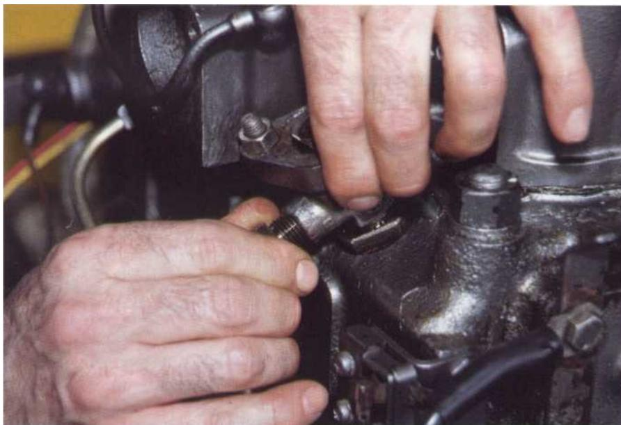
8 N'oubliez pas, lors du remontage, de présenter et de serrer à la main le tuyau haute pression dans le porte-injecteur, de respecter le couple de serrage de la bride, de serrer le tuyau haute pression, de changer les joints d'étanchéité du retour de gazole ou de les recuire éventuellement.
