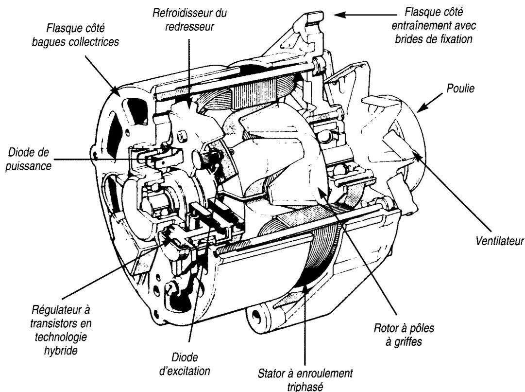
Pour doser le débit en fonction des charges demandées par les consommateurs et maintenir constante la tension délivrée, un régulateur, intégré ou séparé de l'alternateur, assure la modification du courant d'excitation du rotor.
