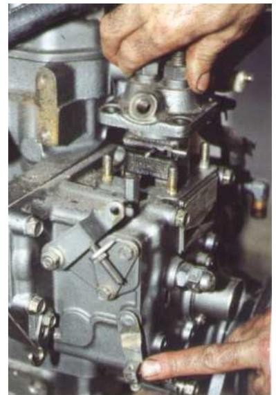
6 Maintenez le levier d'arrêt dans la position énoncée puis reposez la pompe. Celle-ci doit pouvoir être introduite sans résistance jusqu'à une distance de 4 ou 5 mm du carter de distribution.
