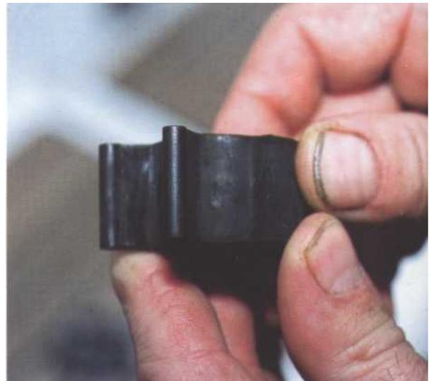
**7** *Ici le mal est moins visible mais on constate tout de même des amorces de rupture à la base des pales. Pour plus de sécurité, remplacez la turbine et gardez celle-ci en rechange éventuelle. Malgré le prix prohibitif, n'hésitez jamais à changer les éléments, tels que les plaques, la turbine et quelquefois le corps de pompe, qui n'apparaissent pas en parfait état. Il en va de la longévité de votre moteur.*
