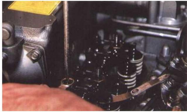
5 Pour modifier le jeu, il suffit de desserrer le contre-écrou de réglage à l'aide d'une clé à veil, puis de régler avec un tournevis. La cale doit pouvoir coulisser sans forcer mais aussi sans jeu. Resserrez le contre-écrou tout en maintenant la vis de réglage avec le tournevis afin d'éviter que le réglage bouge. Une fois le contre écrou bloqué, revérifiez le réglage.
