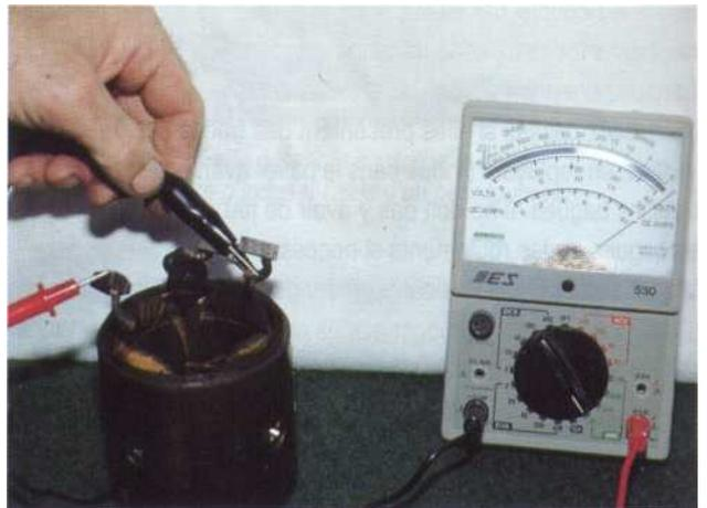
*15 Testez la continuité de l'enroulement de l'inducteur. Si la continuité est bonne, l'enroulement est bon. Contrôlez aussi son isolement en vérifiant la continuité entre une extrémité de l'enroulement et la carcasse. S'il y a continuité, l'enroulement n'est plus isolé, il doit être remplacé.*
