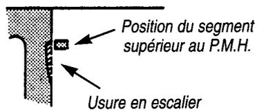
**Lorsque le piston est au PMH. (au début du 3<sup>e</sup> temps Explosion/Détente), la pression dans le cylindre est élevée. Les segments appuient très fort sur le haut du cylindre. C'est aussi à ce moment-là que la température est la plus élevée et que l'huile perd un peu de ses propriétés protectrices. Il en résulte une usure caractéristique dans le haut du cylindre.**
