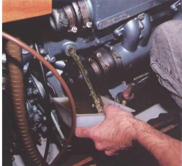
*7 Vidangez de nouveau. Notez cette fois encore le débit et la couleur. L'orifice s'est débouché, la solution de nettoyage est chargée de dépôt de tartre et de résidu de rouille. Revisssez la vis de vidange, puis remplissez le circuit d'eau douce. Faites tourner le moteur pendant 5 minutes, vidangez de nouveau. Renouvelez l'opération de rinçage jusqu'à ce que l'eau de vidange soit claire et exempte de saillure.*
