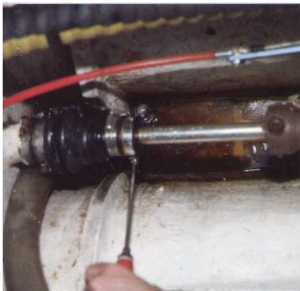
1 Cette génération de presse étoupe qui n'utilise plus de tresse, tend vers l'étanchéité totale. L'étanchéité est assurée à l'aide de deux bagues. Une fixée sur l'arbre d'hélice et l'autre sur un tube soufflet en caoutchouc. L'élasticité du soufflet permet de maintenir en contact les deux bagues sous une légère pression. Le réglage de la pression de la bague d'arbre d'hélice sur la bague montée sur le soufflet conditionne l'étanchéité.
