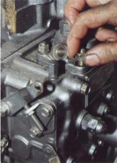
1 Lorsque vous déposez la pompe, dévissez puis déposez en premier lieu les tuyaux haute pression de la conduite d'alimentation. Dévissez ensuite les écrous de fixation de la pompe.
