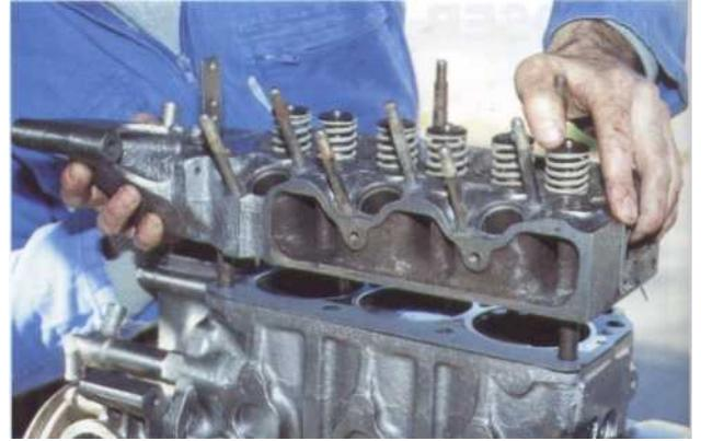
*2 Nettoyez les plans de joint. Toutes les surfaces doivent être parfaites que ce soit sur le bloc ou sur la culasse. Remontez la culasse.*
