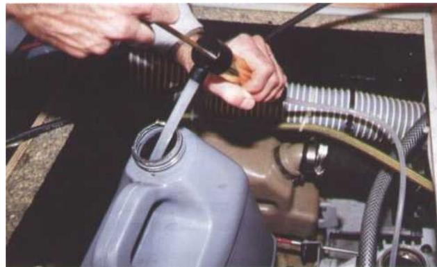
2 Aspirez par l'orifice de la jauge, à l'aide de la pompe à vidange, l'huile contenu dans l'inverseur.
