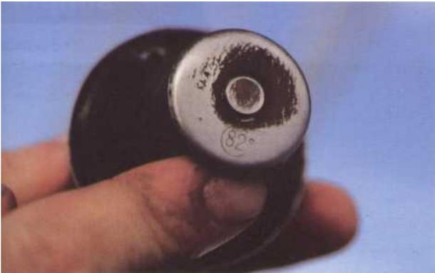
3 Nettoyez le thermostat et relevez sa température d'ouverture. Ici, 82°. Examinez le thermostat pour détecter toutes détériorations. S'il est endommagé, ouvert à froid ou fortement entartré, il est nécessaire de le changer.
