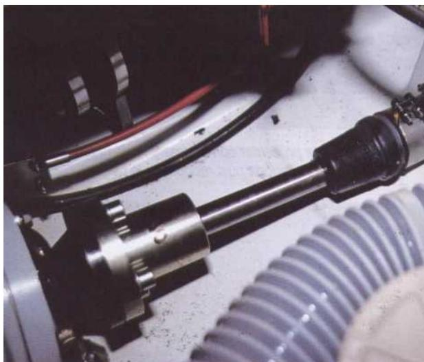
*1 D'un entretien réduit, le presse étoupe à lèvres est un des plus présents sur les bateaux d'aujourd'hui. D'un montage simple et rapide, il ne nécessite qu'un entretien réduit. Le graissage intervient toutes les 200 heures environ et le remplacement toutes les 500 heures de service ou tous les cinq ans.*
