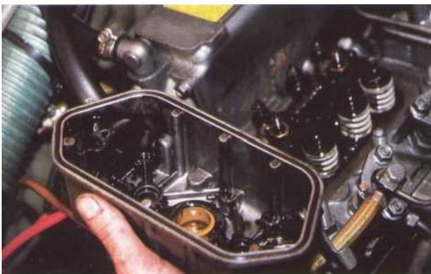
8 Examinez le joint. Dans le cas d'un joint torique, s'il présente la moindre craquelure ou déformation, changez-le. Si le joint est en papier, remplacez-le. Le coller à la graisse ou à la pâte à joint sur le cache culbuteur. Reposez le cache-culbuteurs sur la culasse, veillez à son centrage.
