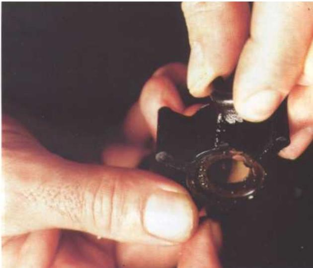
**6** *Inspectez la turbine. Là, aucune hésitation les pales sont arrachées. Il faut changer la turbine.*
