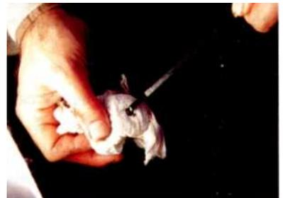
*un appoint d'huile n'oubliez pas d'attendre quelques minutes avant de contrôler le niveau pour permettre l'huile de descendre jusqu'au carter*
