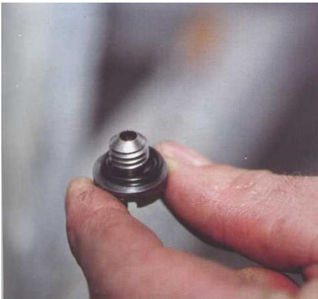
6 Contrôlez le joint torique assurant l'étanchéité de la vis, le changer au moindre doute, à la moindre craquelure. Vérifiez aussi qu'il soit encore souple.
