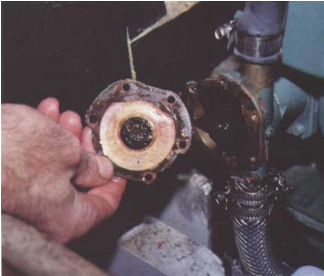
**4** *La plaque déposée laisse apparaître la turbine dans son corps de pompes. Remarquez les profondes rayures sur la plaque. Celle-ci est bien usée. Il est possible pour vous dépanner, de la rectifier sur un marbre avec du papier de verre ou de la retourner en ayant pris soin auparavant d'enlever la peinture.*
