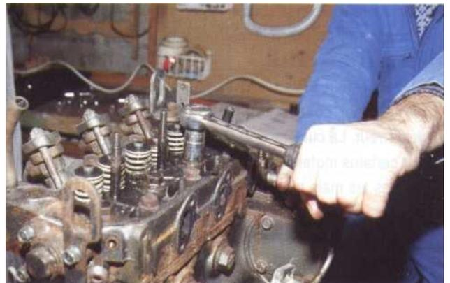
8 Desserrez les vis qui maintiennent la culasse sur le bloc en commençant par les vis les plus extérieures pour terminer par celles du centre. Ces vis ou écrous étant serrés très fort, utilisez une douille montée sur un carré. Si nécessaire, augmentez le bras de levier à l'aide d'un tube.
