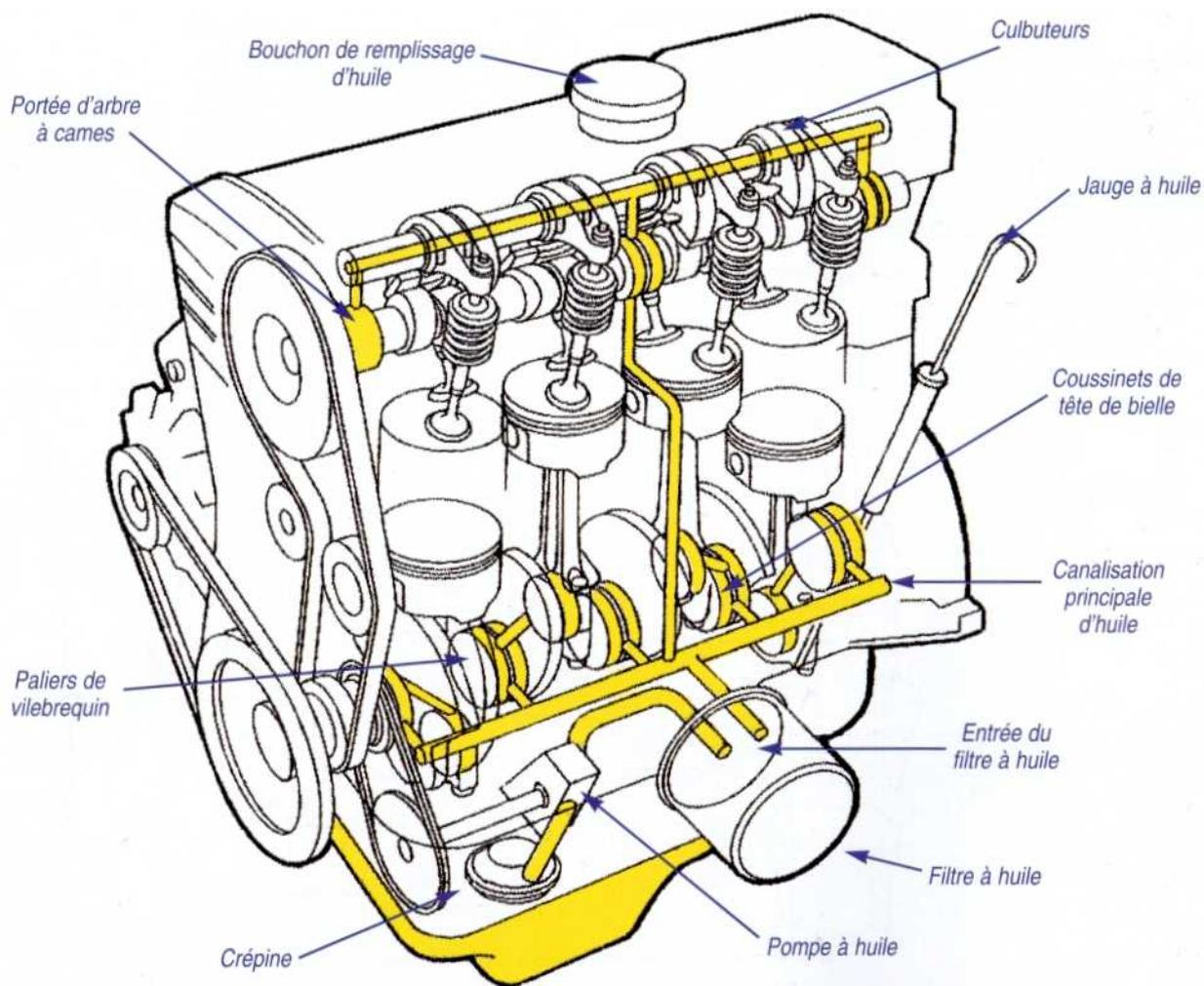
Que celui qui n'a jamais entendu une bielle coulée se rassure, ce type de dysfonctionnement devient de plus en plus rare. Pour s'en prémunir, utiliser une huile de bonne qualité, contrôler régulièrement votre niveau d'huile et effectuer l'entretien du circuit de graissage aux intervalles préconisés par le constructeur.
