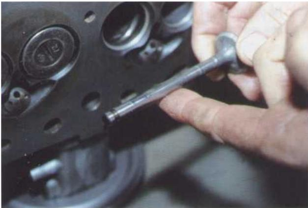
**19** Huilez avec de l'huile moteur neuve les tiges de soupape. Pensez à nettoyer avant de renfiler les soupapes dans leurs guides ; il ne doit subsister aucune trace de pâte à roder.
