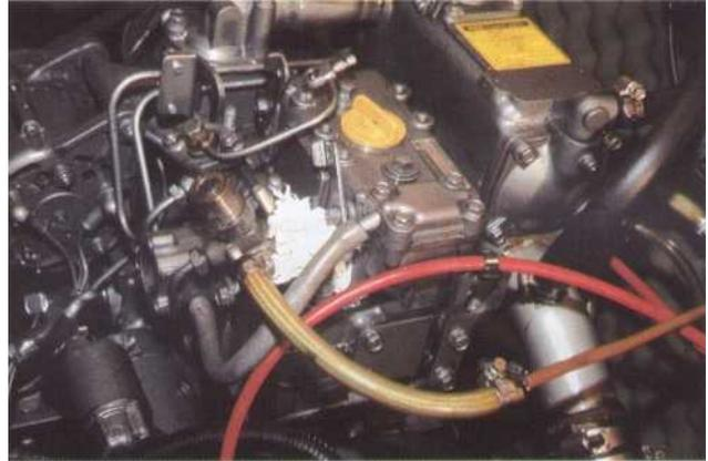
b Obturez le logement de l'injecteur dans la culasse afin d'éviter qu'un corps étranger pénètre dans le moteur.
