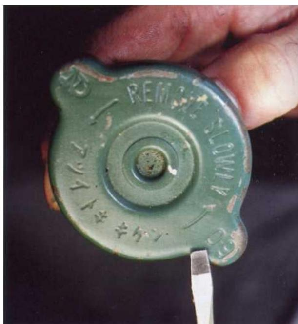
*2 Sur le bouchon est marquée la pression de tarage du clapet de surpression qui permet d'augmenter la température de fonctionnement du moteur sans atteindre l'ébullition. On améliore ainsi la combustion et le rendement du moteur.*
