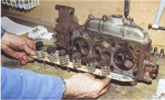
7 Toutes les soupapes sont déposées. Il faut maintenant les nettoyer soigneusement avant de pouvoir les examiner.
