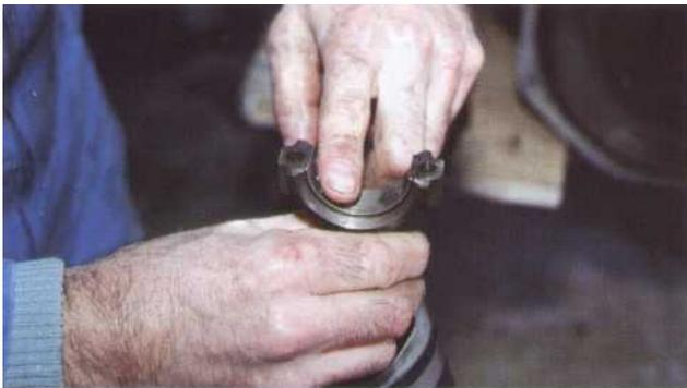
**11** Lubrifiez les coussinets et les manetons.
