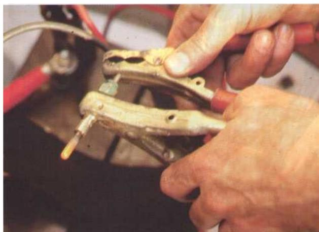
8 Au bout de quelques secondes, la bougie doit commencer à chauffer puis rougir sur presque toute sa longueur. Coupez l'alimentation au bout de 10, 15 secondes afin de ne pas endommager la bougie. Si une bougie ne fonctionne pas, il est de bon ton, pour ne pas déséquilibrer le système de préchauffage, de changer l'ensemble des bougies. Gardez les bonnes en dépannage.
