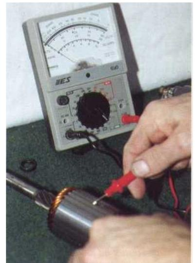
*16 Vérifiez que le collecteur est bien isolé de la masse de l'induit. Si l'isolement n'est pas bon, remplacez l'induit.*
