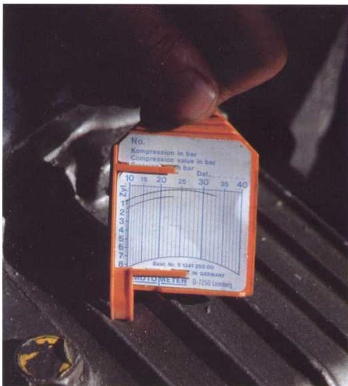
7 Lorsque la mesure est relevé sur tous les cylindres (ici deux cylindres), vous pouvez comparer les valeurs obtenues avec celles données par le constructeur. La ou les valeurs relevées pour chaque cylindre doivent être au moins égales au chiffre du rapport volumétrique.
