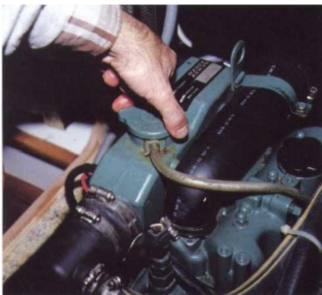
*1 Si votre moteur est chaud, ouvrez avec précaution le bouchon de remplissage du système de refroidissement du moteur car il peut se produire un échappement de vapeur ou de liquide quatre saisons chaud. Procédez ensuite comme suit protégez-vous les mains avec un chiffon épais puis tournez le bouchon pressurisé jusqu'à sa première butée pour laisser s'échapper la pression. Retirez le bouchon.*
