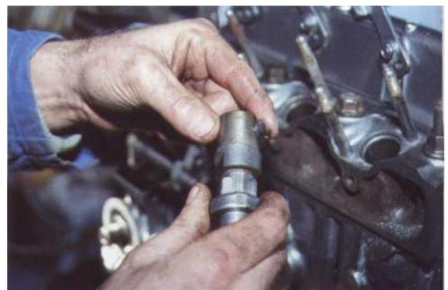
*6 La suite du remontage s'effectue dans l'ordre inverse de celui du démontage. Graissez à la graisse graphitée les injecteurs avant de les enfiler dans la culasse.*
