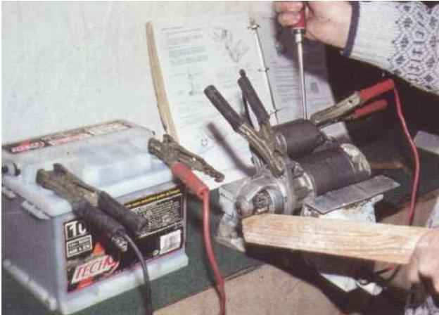
**22** Vérifiez la bonne rotation et le couple du démarreur à l'établi. Cette vérification s'effectue en freinant le lanceur à l'aide d'un coin de blocage en bois. Si le couple est important et la vitesse de rotation élevée, le démarreur est en bon état. Une faible vitesse de rotation ou un couple faible traduit un dysfonctionnement du démarreur.
