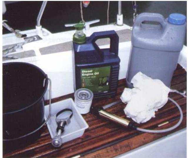
*La vidange du moteur ne nécessite qu'un matériel limité. La démarche est pratiquement identique pour tous les groupes propulseurs. Une règle commune : la vidange s'effectue lorsque le moteur a atteint sa température de fonctionnement.*
