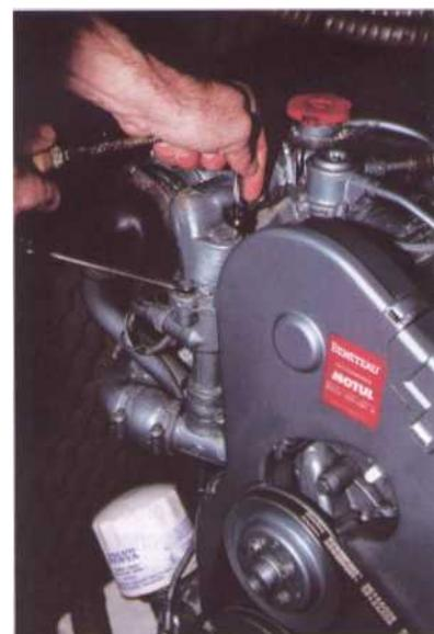
8 Revissez la cloche sur un joint neuf, replacez puis serrez la durit. N'oubliez pas de refaire le plein de liquide quatre saisons dans le cas d'un système à refroidissement indirect comme dans l'exemple traité.
