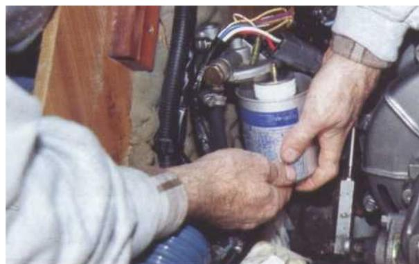
*6 Enfilez un élément filtrant neuf sur sa coupelle. Vérifiez que les surfaces de contact sont bien propres. Assemblez puis serrez le filtre.*
