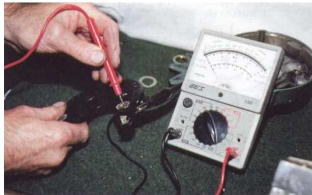
8 Contrôle du pont de diodes.
