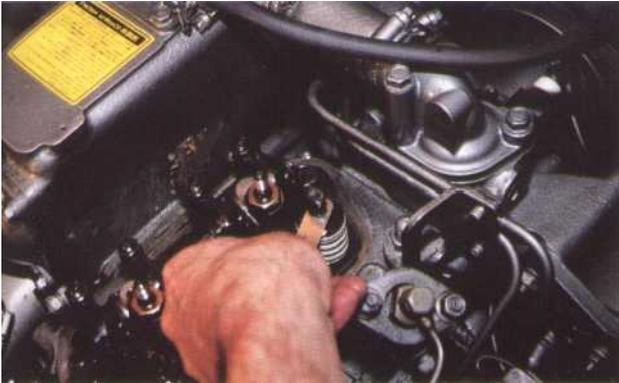
4 Après avoir mis en phase le moteur (voir les tableaux de positionnement page 118), glissez la cale entre la queue de la soupape et l'extrémité du culbuteur. Si la cale nage, vous devrez réduire le jeu. Si la cale ne passe pas, il faudra l'augmenter.
