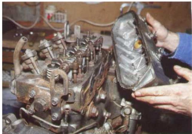
4 Pour accéder aux vis de la culasse, il est nécessaire de déposer la rampe de culbuteurs.
