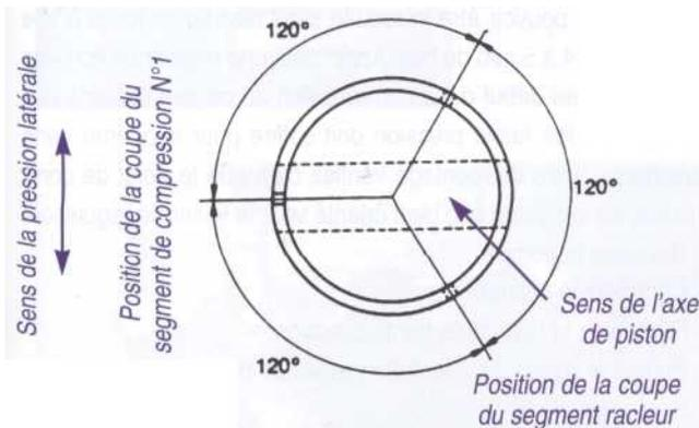
Les segments doivent être placés de façon que les coupes soient espacées de 120°. Ne placer aucune coupe dans la direction de la pression latérale.
