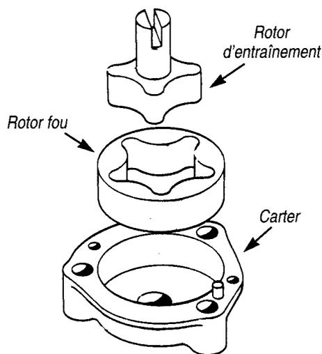
La pompe à huile à rotor se compose de deux rotors excentrés tournant dans un carter muni d'orifices d'aspiration et de refoulement.
