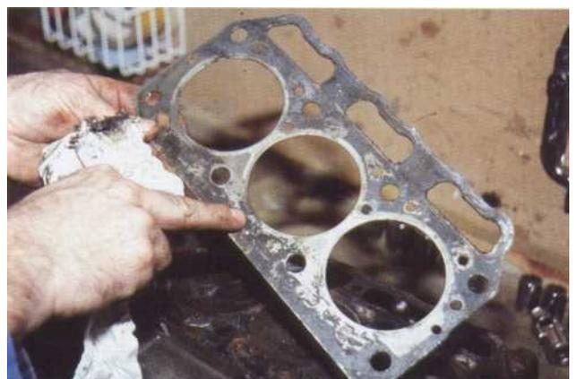
10 Traquez les signes de fuite sur le joint de culasse. Une trace noire sur le sertissage résultant des résidus de combustion est le signe d'une mauvaise étanchéité.
