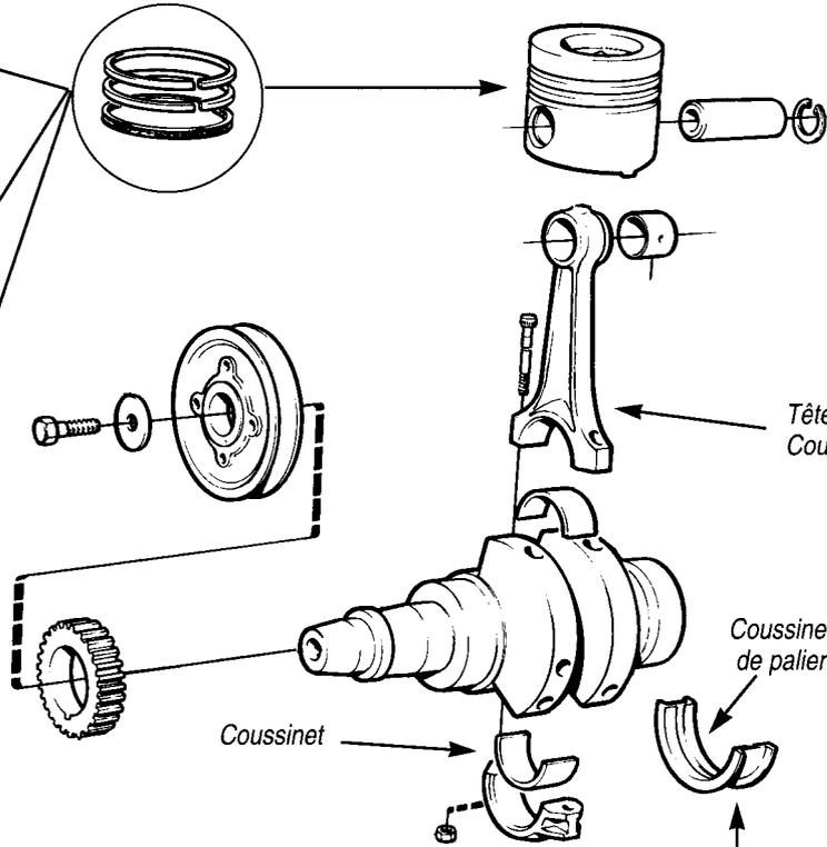
\* La tête de bielle en oblique permet la dépose de l'ensemble bielle piston par le haut du cylindre.
