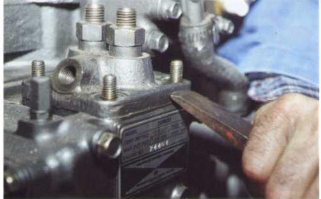
2 Pour décoller la pompe, tapez à l'aide d'un burin et d'un marteau sur le flan de celle-ci. N'introduisez jamais un tournevis ou le burin entre le plan de joint.
