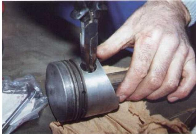
*2 Mise en place des clips de maintien. En réassemblant piston et bielle, assurez-vous qu'ils proviennent bien du même cylindre. De même, vérifiez le sens de montage de la bielle. Ne vous trompez pas de sens. Généralement, sur les pistons à axe déporté, un repère indique le sens de rotation du moteur.*
