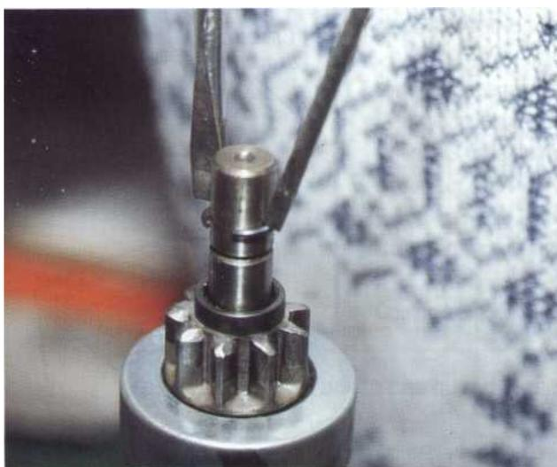
**19** Lors du réassemblage du lanceur sur l'induit, lubrifiez légèrement les cannelures. Enfilez la butée du lanceur puis faites glisser le circlip sur l'extrémité de l'arbre de l'induit jusqu'à sa gorge.
