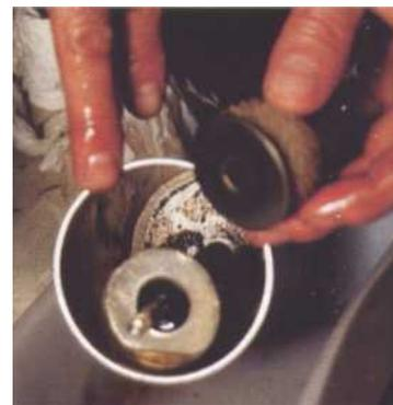
*5 Nettoyez la cuve. N'oubliez pas de changer le joint d'étanchéité avant le remontage.*
