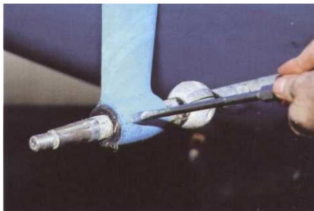
2 L'échange de la bague nécessite la dépose de l'hélice.
