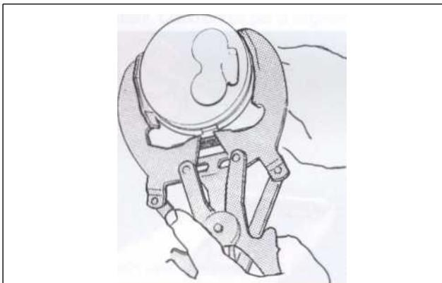
7 Les segments sont des pièces fragiles, si vous en avez la possibilité, utilisez une pince à segment. Vous éviterez ainsi le risque de blessure, une rupture due à un écartement trop important, une déformation due à une torsion excessive, une détérioration du piston.
