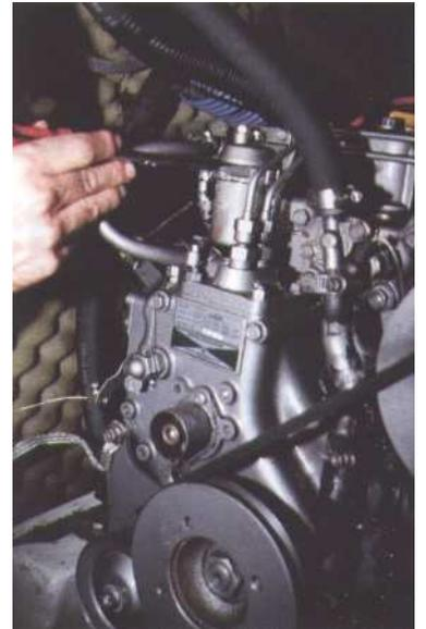
8 Comme lors de la dépose, frappez légèrement sur l'écrou du filtre avec un burin et un marteau pour le visser. Pour les autres marques, vissez la cartouche à la main jusqu'à ce qu'il rentre en contact avec le support du filtre, faite ensuite un demi à trois quarts de tour supplémentaire.
