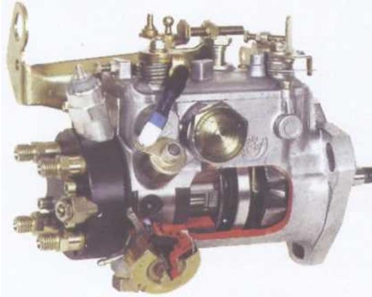
Contrairement au type de pompe décrit précédemment, la pompe d'injection rotative, introduite dans le but de réduire le coût du dispositif d'injection, ne possède qu'un seul élément de pompage pour tous les cylindres et un distributeur rotatif qui aiguille le gazole vers les différents cylindres.
