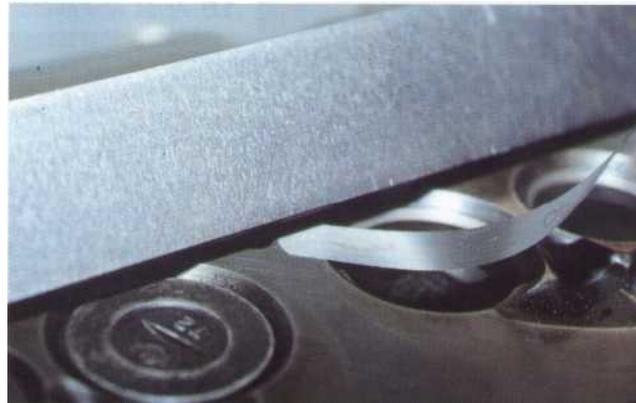
**12** Vérifiez la planéité de la culasse. La face d'appui de la culasse doit être parfaitement propre. La déformation de la culasse provoque des dommages au joint de culasse, des fuites de compression. Essayez de glisser une cale entre le plan de joint et la règle rectifiée.
