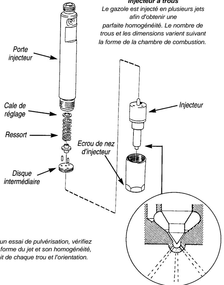
Lors d'un essai de pulvérisation, vérifiez bien la forme du jet et son homogénéité, le débit de chaque trou et l'orientation.
