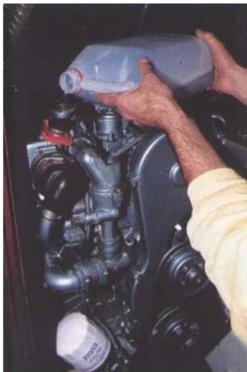
*6 Remplissez le circuit d'eau douce, puis faites tourner le moteur 15 minutes au minimum.*
