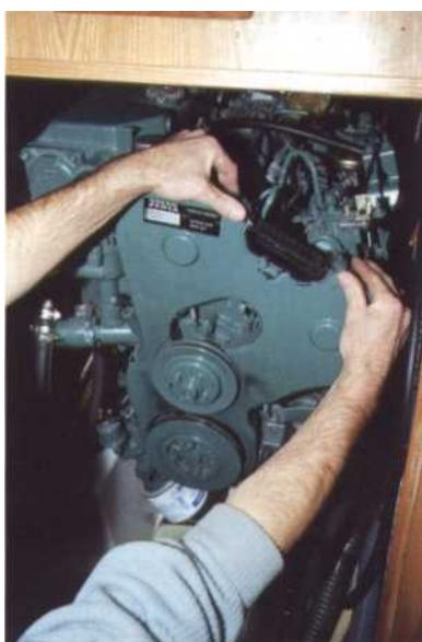
1 Contrôlez tous les ans la courroie de l'arbre à cames. Celle-ci doit être remplacée toutes les 2000 heures de service ou avant lorsque vous décelez des signes d'usure ou des craquelures.
