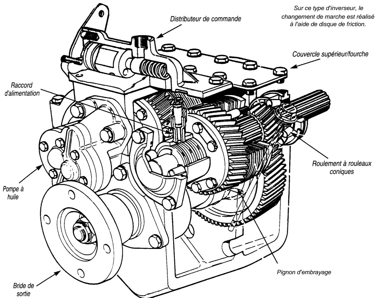
Le patinage d'un cône ou des disques de friction permet un enclenchement en douceur. La lubrification par barbotage des parties tournantes représente la solution la plus courante mais aussi la plus simple tout en étant efficace. Le choix du type d'huile et son renouvellement sont fonction de la technologie de l'inverseur ; il est spécifié sur la notice d'entretien du groupe propulseur, fournie par le constructeur.
