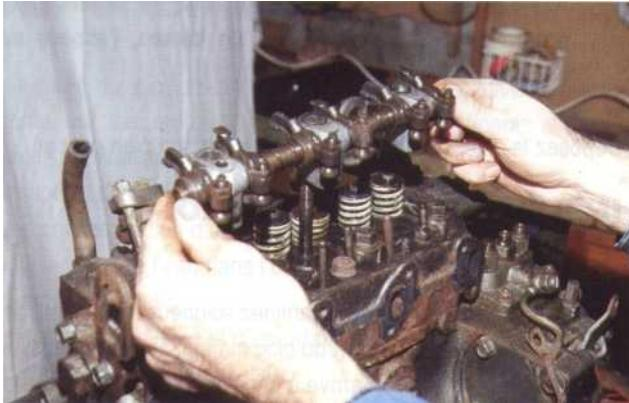
5 Lorsque tous les écrous ou les vis fixant la rampe de culbuteurs sont enlevés, déposez-la. Rangez soigneusement toutes les vis que vous avez démontées après avoir repéré leur emplacement d'origine afin de les remonter au même endroit.
