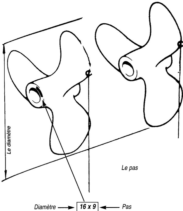
Le marquage du diamètre et du pas s'effectue le plus souvent sur le moyeu de l'hélice.
