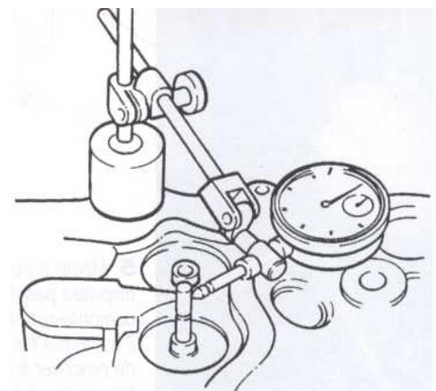
Contrôlez l'usure des guides de soupapes à l'aide d'un comparateur.
