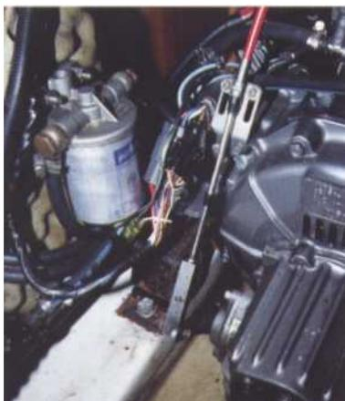
*1 Repérez en premier lieu l'emplacement du pré filtre. Celui-ci est toujours monté en série entre le réservoir et la pompe d'alimentation. Son rôle est de filtrer les plus grosses impuretés. Une vis située dans sa partie basse permet de purger l'eau.*
