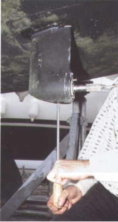
**8** Bloquez la vis. Certain constructeur préconise un couple de serrage à respecter. Exemple Volvo bouchon de vidange d'huile 10 + ou - 5 Nm
