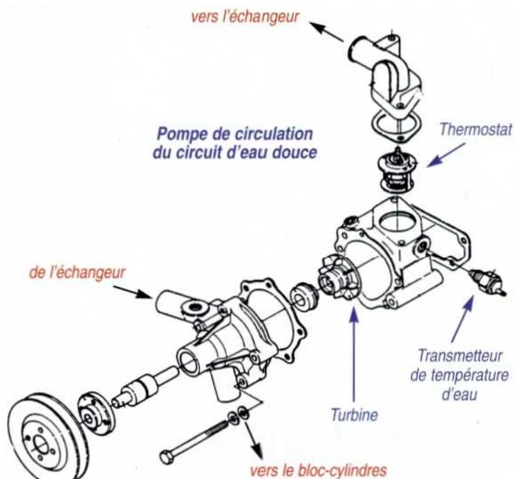
L'entraînement de la pompe de circulation est réalisée par l'intermédiaire d'une courroie
