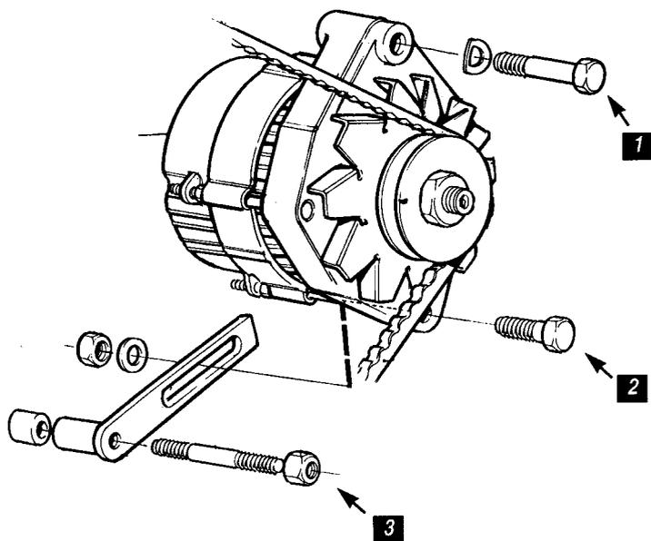
Le réglage de la tension de la courroie d'entraînement de l'alternateur s'effectue en faisant pivoter l'alternateur sur ses axes de fixation 1, 2, 3.
