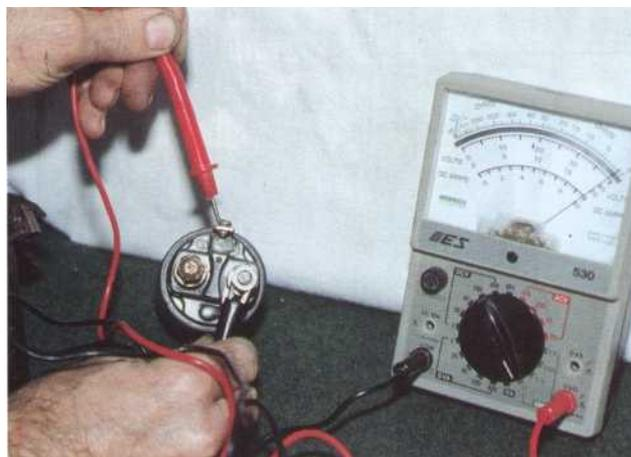
**18** Le contrôle de l'enroulement d'attraction se vérifie entre la borne excitation du solénoïde et la borne sortie coté inducteur, celui de l'enroulement de maintien, entre la borne excitation et la masse.
