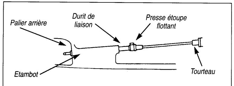
**Le montage souple :** ce type de montage entièrement souple tend à réduire au maximum les vibrations. L'étanchéité de la ligne d'arbre est assurée par un presse-étoupe flottant. Une chaise munie d'une bague hydro-lube assure le guidage de l'arbre dans sa partie arrière.
