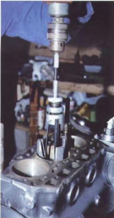
**10** Si les cylindres présentent des rayures ou des taches, il est nécessaire de les rectifier avec une rectifieuse montée sur une perceuse. Si l'usure ou les rayures sont faibles, une rectification suffit ; dans le cas contraire, il sera nécessaire de recourir à l'alésage des cylindres à une cote de réparation supérieure.
