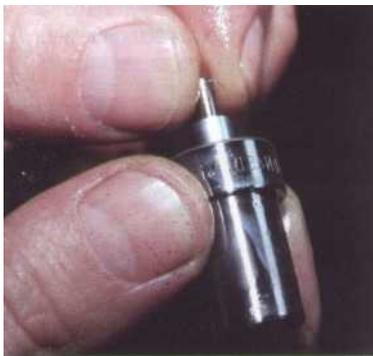
4 Après avoir lavé le nez de l'injecteur dans du gazole propre, vérifiez le bon coulisement de l'aiguille, celle-ci doit descendre de son propre poids. Si l'aiguille accroche ou glisse irrégulièrement, remplacez le nez d'injecteur.
