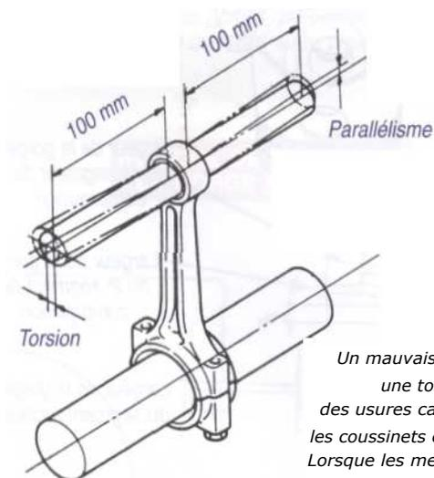
Un mauvais parallélisme ou une torsion induit des usures caractéristiques sur les coussinets et dans le cylindre. Lorsque les mesures dépassent la limite prescrite, il est nécessaire de remplacer la bielle.
