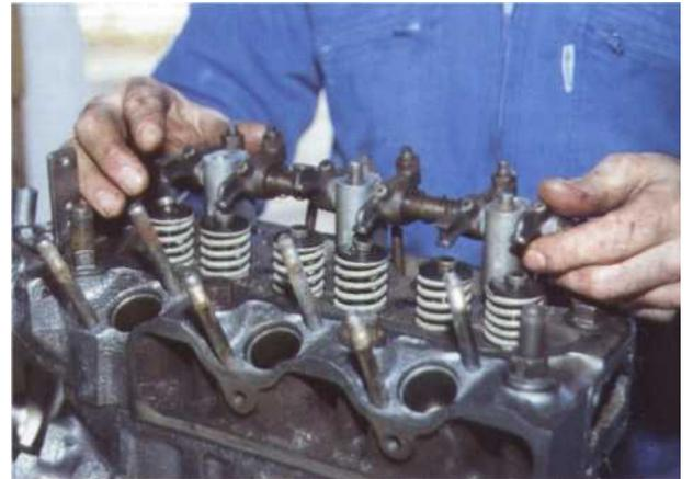
*4 Renfilez les tiges de culbuteurs dans leurs poussoirs, posez les butées sur les soupapes (Yanmar), remontez la rampe de culbuteurs. Serrez progressivement et respectez, là aussi, le couple de serrage.*
