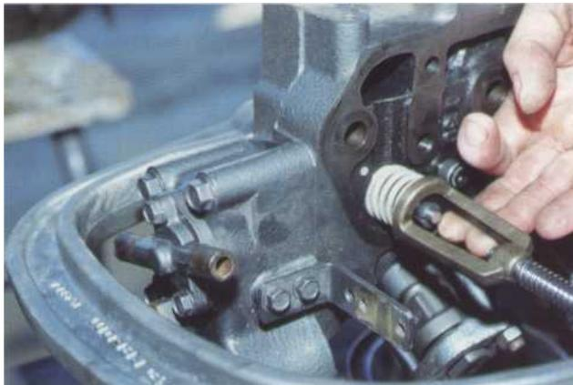
**21** Veillez à bien positionner les clavettes dans leur logement. Frappez ensuite au marteau sur les queues de soupape pour s'assurer du parfait montage des clavettes dans leur logement.
