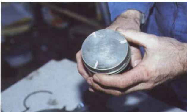
9 Tiercez les segments. Orientez dans trois axes différents les coupes afin que celle-ci ne soit jamais en face. Attention la coupe du segment racleur doit de situer entre 90° et 120° de l'axe du piston. 90° lorsqu'il y a 4 segments, et 120° lorsqu'il y a 3 segments.
