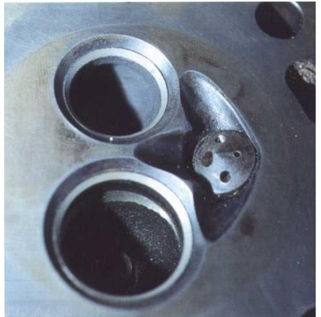
**16** La surface de la portée après nettoyage doit être d'un gris satiné uniforme. Aucune trace de corrosion de piquûre ne doit subsister.
