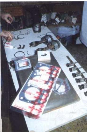
*1 Lors du remontage, il faudra remplacer tous les vieux joints par des neufs. Les constructeurs fournissent les joints à la pièce ou proposent des pochettes de joint pour le haut du moteur et pour le bas moteur.*
