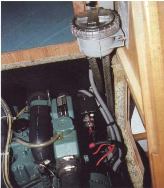
Le filtre à eau est un élément de sécurité indispensable. Situé au-dessus de la flottaison, l'élément filtrant peut être nettoyé facilement.
