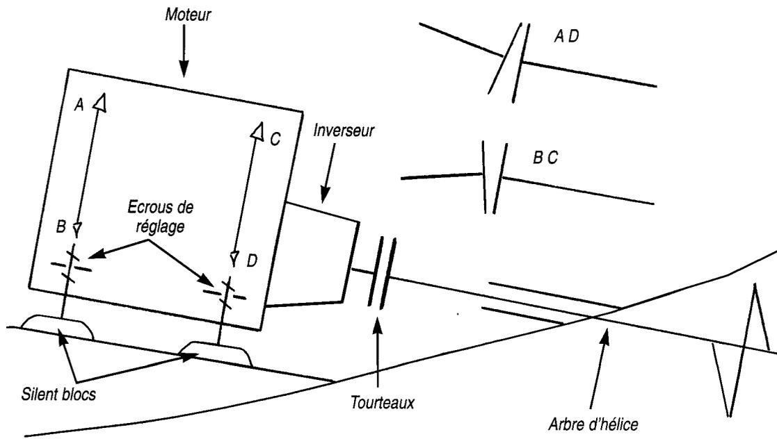
**ACTION DE LA POSITION DU MOTEUR SUR L'ARBRE D'HÉLICE, ALIGNEMENT LATÉRAL**
