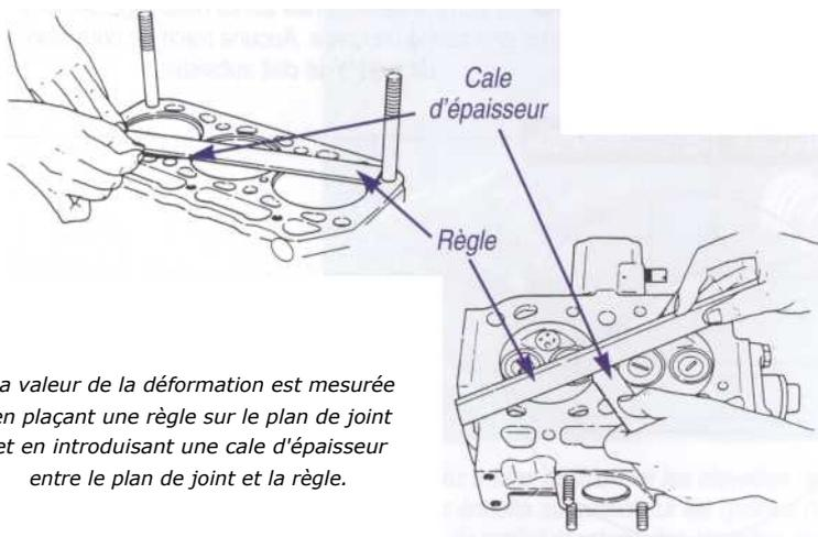
La valeur de la déformation est mesurée en plaçant une règle sur le plan de joint et en introduisant une cale d'épaisseur entre le plan de joint et la règle.
