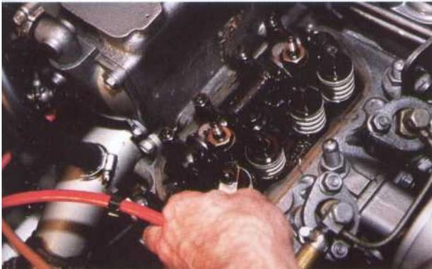
6 Positionnez le moteur pour une nouvelle phase de réglage et réglez les autres soupapes de la même manière.
