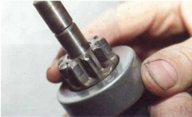
*12 Remplacez le lanceur si les dents présentent des marques d'usure. Vérifiez le dispositif de débrayage. Celui-ci doit patiner librement dans un sens et se verrouiller dans l'autre. S'il patine librement dans les deux sens, le dispositif de débrayage est défectueux, il doit être remplacé.*
