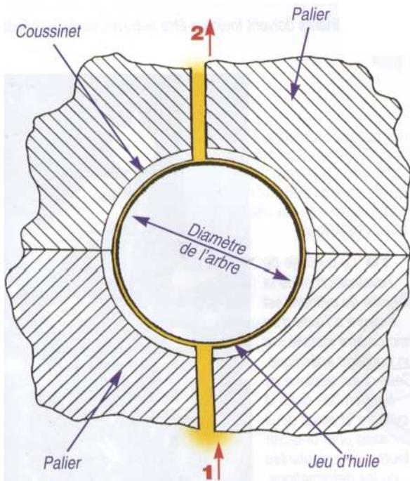
Chaque ensemble à graisser comporte une arrivée d'huile sous pression 1 et un départ vers d'autres éléments à graisser du circuit 2.
