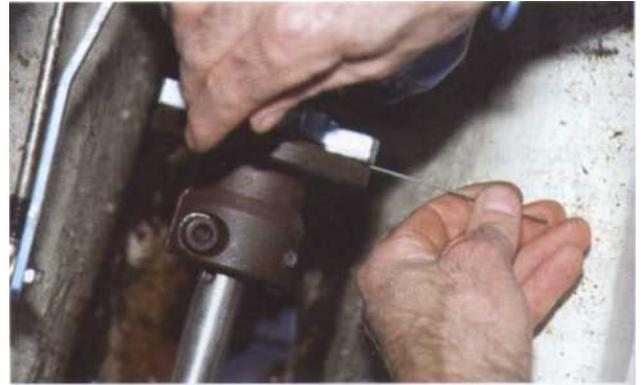
**4** Comparez ensuite les dimensions des intervalles B, C et D. Si le désalignement est supérieur à 5 microns par centimètre de diamètre de tourteau, il faut réaligner la position du moteur et de l'inverseur par rapport à l'arbre d'hélice.
