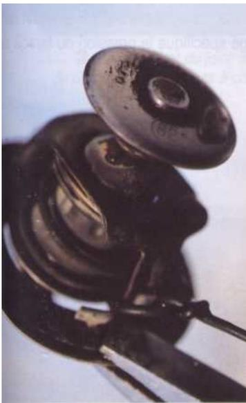
5 En cas de non-ouverture, ou si la température d'ouverture et la course ne sont pas conformes aux données du constructeur, remplacez le thermostat.
