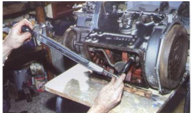
1.e LL euwrnage des écrous de bielle impose un serrage à un couple déterminé par le constructeur. Utilisez une clé dynamométrique.
