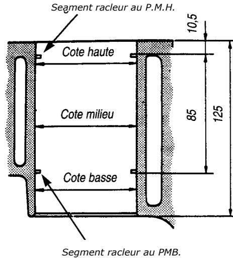
Les mesures que vous allez effectuer ont pour but de déterminer l'usure ou la déformation du cylindre. Elles se font en 3 points du cylindre : cote haute, milieu, basse.
