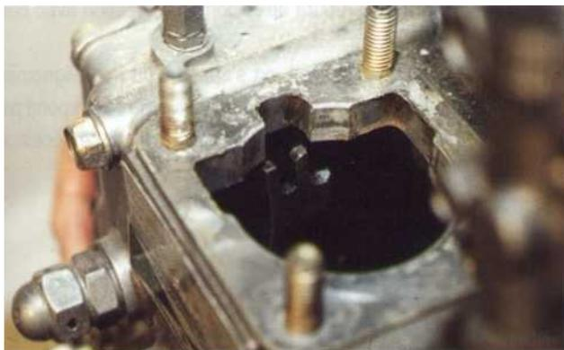
5 Avant de reposer la pompe, repoussez le levier d'arrêt du moteur et faites correspondre, la fente du levier du régulateur avec l'encoche de passage de la crémaillère de la pompe d'injection.
