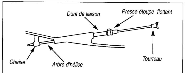
Le *presse étoupe* : situé au passage de l'arbre d'hélice au travers de la coque, cette pièce mythique qui assure l'étanchéité du tube d'étambot sur l'arbre d'hélice est à l'origine de nombreux maux aujourd'hui parfaitement maîtrisés.
