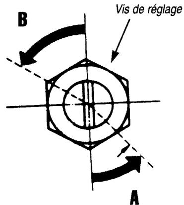
*Il est quelquefois difficile, voire impossible de contrôler le jeu en utilisant une cale. Si tel est le cas, calculez l'angle de desserrage de la vis en tenant compte du pas de la vis de réglage.*
