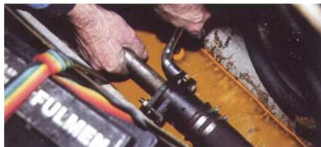
2 A la première mise à l'eau, n'oubliez pas de desserrer le presse étoupe afin de l'irriguer. Si, même desserré, aucun passage d'eau n'est visible et que le presse étoupe chauffe, dévissez complètement le fouloir et faites le glisser sur l'arbre.
