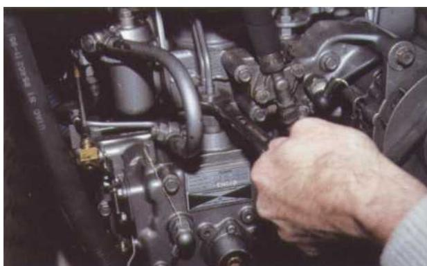
**10** *Après avoir installé le tube de contrôle, faites tourner le moteur à la main quelques tours pour faire monter le gazole dans le tube. Alignez à l'aide de la vis de purge, le niveau. Le début de la montée du gazole dans le tube signale le début d'injection.*
