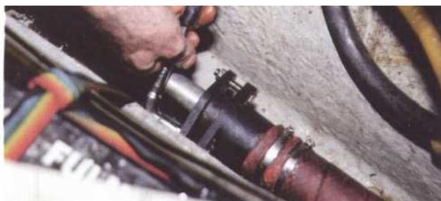
3 Vous remarquerez que la cale a été nettoyée ! Il faut maintenant resserrer les écrous du fouloir simultanément. L'arbre d'hélice doit pouvoir tourner à la main. Il est normal qu'une goutte à goutte se produise. Le réglage correct doit laisser passer une goutte d'eau toutes les trente secondes environ. Si le fouloir est presque à fond de réglage, il sera nécessaire de regarnir le presse étoupe.
