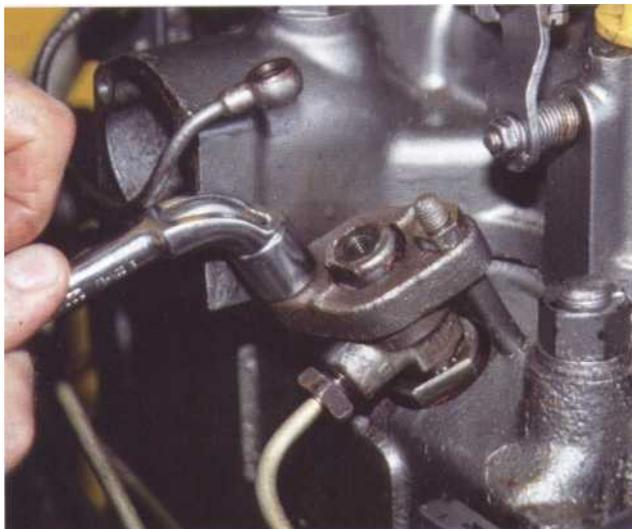
*4 Desserrez la bride, dévissez complètement le tuyau haute pression puis déposez l'injecteur.*
