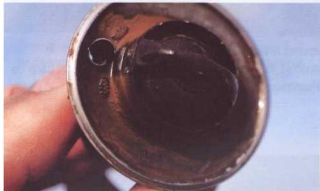
6 Vérifiez que le clapet repose bien sur son siège en position repos autrement dit en position fermé.
