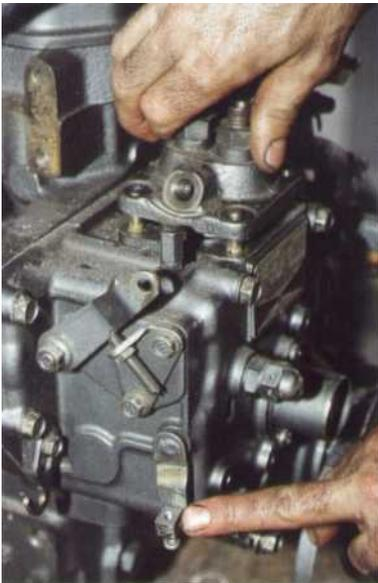
3 Une fois la pompe décollée, repoussez le levier d'arrêt moteur de quelques centimètres.
