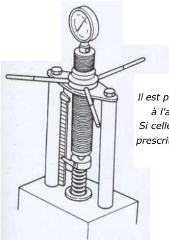
Il est possible de vérifier la tension à l'aide d'un outil spécifique. Si celle-ci est inférieure à la limite prescrite, il est nécessaire de remplacer le ressort.
