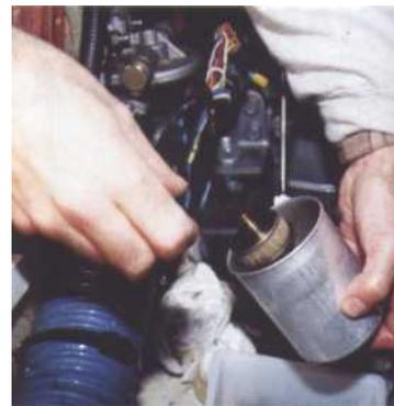
*4 Que de dépôt ! L'échange de l'élément filtrant ainsi que le nettoyage de la cuve est réellement une opération indispensable.*
