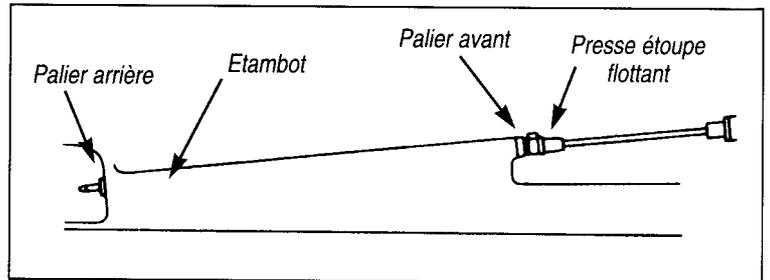
**Le montage semi-rigide :** c'est une solution intermédiaire entre le montage souple et le montage rigide.
