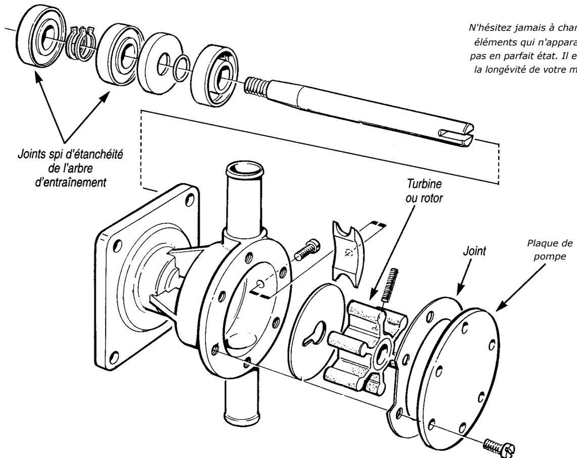
Dans une cale exiguë, il est parfois plus facile de déposer entièrement la pompe, en déposant les durits et les vis de fixation de celle-ci.
