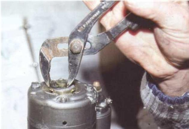
**21** Remonter dans l'ordre inverse du démontage le démarreur. Graissez légèrement le palier avant et arrière et n'oubliez pas la rondelle et la cale d'épaisseur avant de remettre en place le circlip à l'aide d'une pince.
