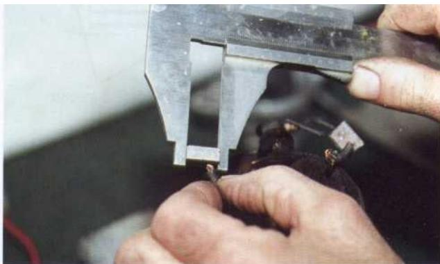
*14 Vérifiez la longueur des balais pour savoir ce qui leur reste de durée utile. Les remplacer s'ils sont usés au-delà de la limite permise. Si les balais nécessitent un remplacement, coupez les balais, près de la barre de connexion pour le balai positif, au ras du porte balai pour le balai négatif. Enlevez tout le vernis et soudez au fer à souder une paire de balai neuf.*
