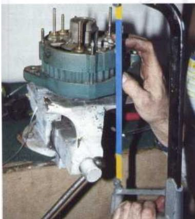
2 Avant de désassembler l'alternateur, effectuez des repères d'alignement des paliers. Sur la photo, un petit coup de scie nous permettra de positionner les pièces correctement lors du réassemblage.
