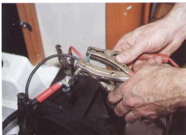
7 Alimentez sous une tension d'environ 10 volts la bougie à l'aide de câble à batterie. Une batterie 12 volts avec une résistance d'appoint branchées en série fait très bien l'affaire.
