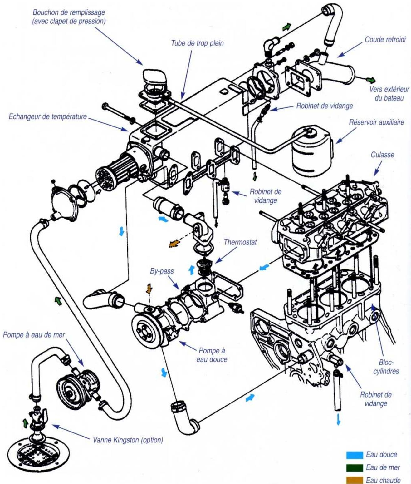
**Détail de plan de circulation au niveau de l'échangeur des circuits d'eau douce et d'eau de mer**
