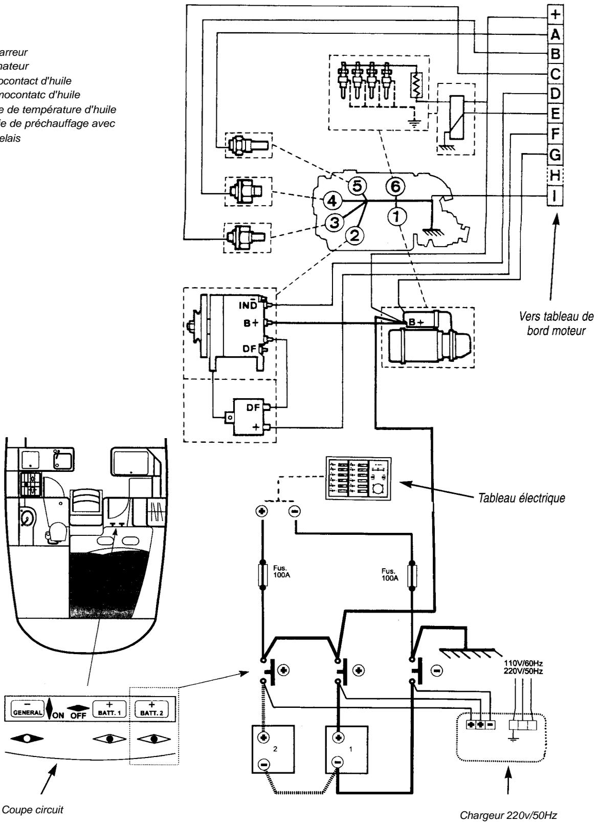
Le système électrique se compose
