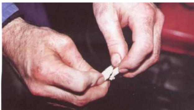
*6 soupez la Tresse au atamerre ce rare et en biseau dans le sens du serrage à l'aide d'un cutter.*
