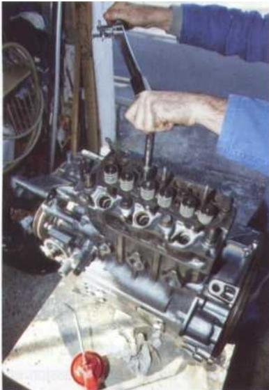
*3 Huilez les vis ou les écrous de culasse, puis serrez une première fois tous les écrous dans l'ordre de serrage préconisé par le constructeur au 1/3 du couple prescrit. Serrez ensuite aux 2/3 puis au couple prescrit.*
