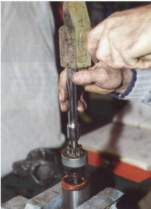
7 Faites sauter la butée du lanceur en arrière du circlip situé à l'extrémité de l'induit côté entraînement. Utilisez pour ce faire un tube possédant un diamètre intérieur légèrement supérieur à celui de l'axe de l'induit. Ici la petite rallonge Facom fait très bien l'affaire.
