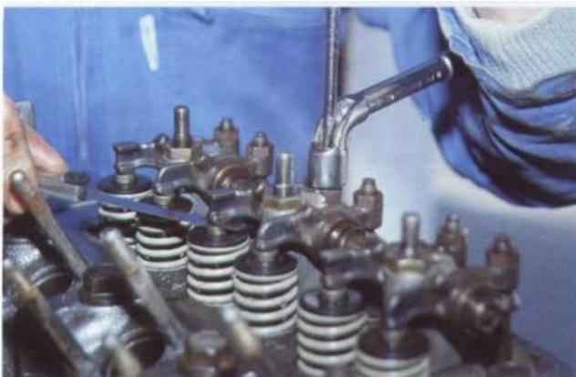
*5 Sur les moteurs culbutés, n'oubliez pas de régler le jeu aux soupapes après le serrage de la culasse et de sa rampe de culbuteurs.*
