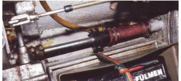
1 La ligne d'arbre avec son presse étoupe traditionnel. S'il existe encore beaucoup de bateaux où l'étanchéité du tube d'étambot sur l'arbre d'hélice est assurée par la compression de trois ou quatre anneaux de tresse autour de la ligne d'arbre, ce système tend à disparaître. Les constructeurs installent aujourd'hui soit un joint tournant, soit un joint à lèvres.
