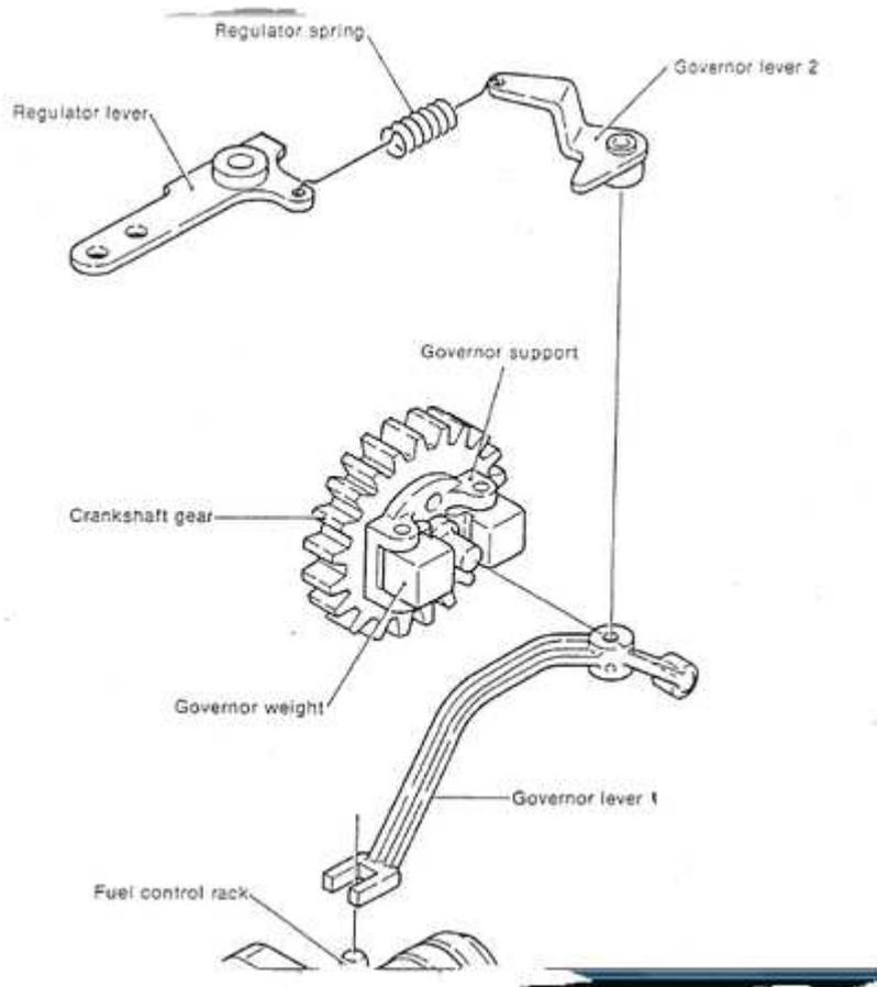
Le système est ultra simple et robuste ,la pompe injection a rampe hélicoïdale est un grand classique la crémaillère fait tourner le piston et la position de la rampe par rapport au trou de la chemise pour un réglage je conseillerais une navigation en eau calme et augmenter le nombre de tours a la valeur prescrite en agissant sur la vis de réglage Fuel injection limiter,si c'est trop le moteur va passer en surcharge et fumer
