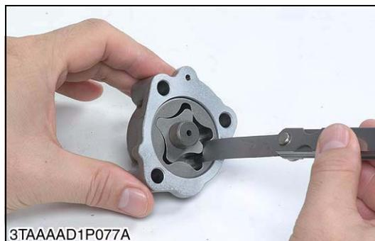
**Jeu entre le rotor intérieur et le rotor extérieur**
