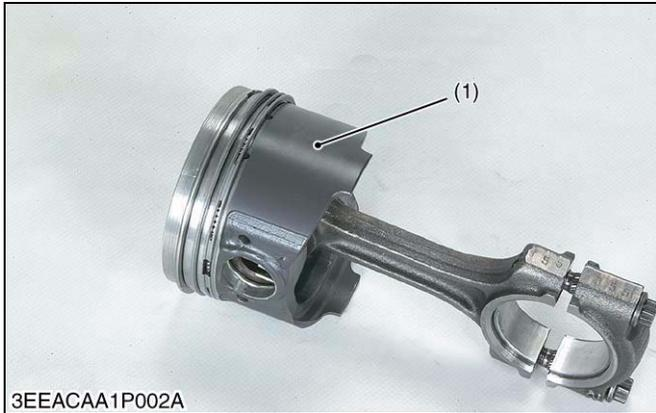
La jupe du piston est recouverte de **bisulfure de molybdène★**, qui réduit le claquement des pistons et par conséquent le bruit de fonctionnement du moteur.
