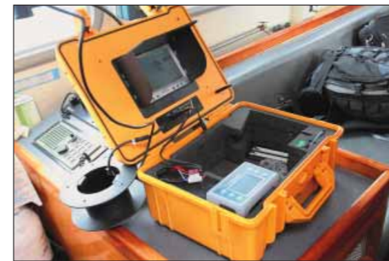
Photo et vidéo ! Notre plongeur photographe était équipé d'une caméra dont les 40 mètres de câble nous permettaient de suivre les décrochages en direct depuis le bateau.
