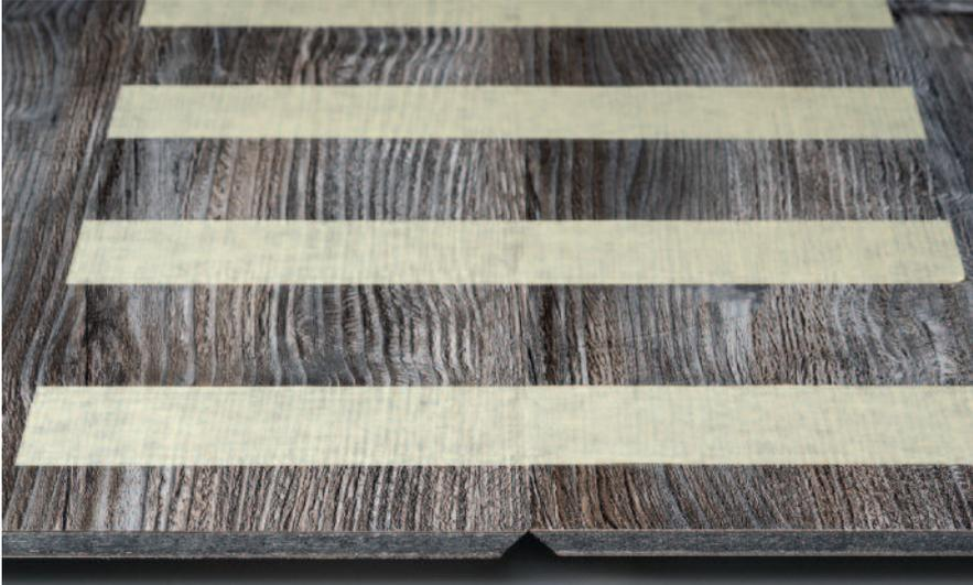
Les extrémités des panneaux **RESOPAL SpaStyling® BOARD** sont découpées à angle droit à l'aide d'une scie circulaire ou d'une scie circulaire portative. Les onglets sont maintenus sur les côtés extérieurs avec une bande adhésive.
