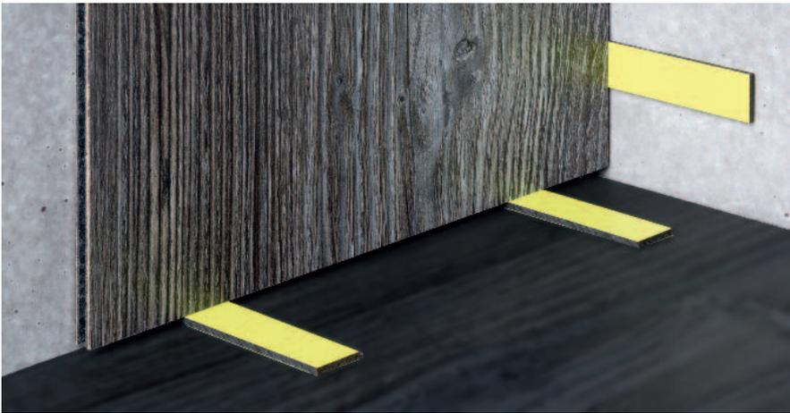
Placer et vérifier d'abord à sec les panneaux confectionnés (sans colle). Veuillez tenir compte du fait que par rapport à tous les éléments de construction (sol, plafond, mur, etc) il faut respecter une distance d'au moins 3 mm.
