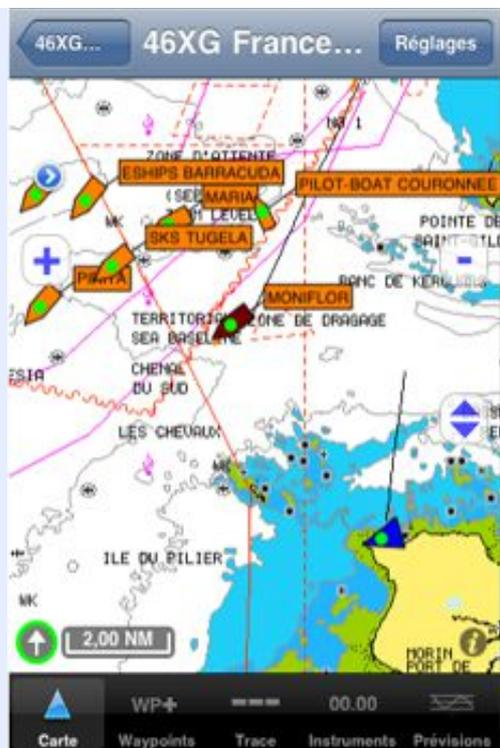
Si des données en provenance d'un récepteur AIS ou Radar sont reçues par iNavX, les cibles seront visibles sur la carte, et la liste des cibles est accessible par un tap sur l'icône **i Informations**.
