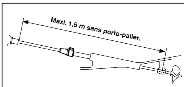
Montez toujours le joint lubrifié par eau sous la ligne de flottaison pour assurer un fonctionnement exact.
