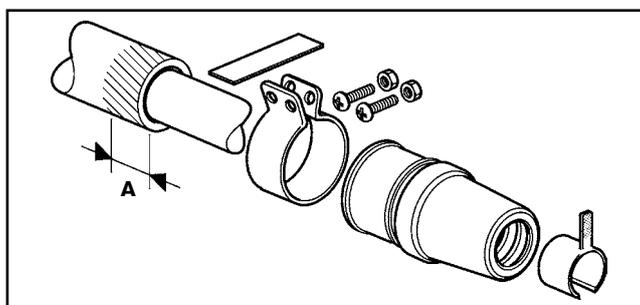
Vérifiez toujours que la longueur minimale à l'extrémité de la douille est de 36 mm (A) pour assurer un assemblage exact.
