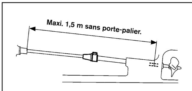
Une condition essentielle est d'avoir un arbre compris dans les tolérances et parfaitement droit sinon l'installation risque d'endommager le joint et des fuites vont se produire dans le bateau.
