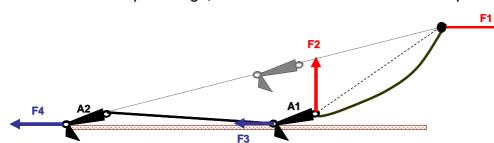
s'applique au point de fixation de la ligne de mouillage. La force F1 tire et, a cause de la force F3, oblige la ligne de mouillage à se tendre appliquant ainsi une force F2 sur
