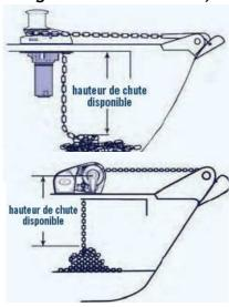
Posent plus de problème d'intégration sur le bateau à cause de la hauteur nécessaire dans la baille à mouillage (hauteur du moteur). Convient aux puits de chaînes dont la hauteur de chute est de 40 cms minimum. La partie moteur sous le pont représente en moyenne 15 cms.
