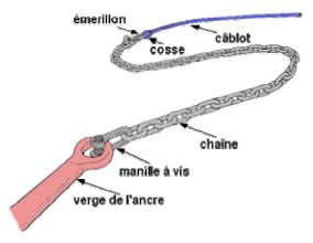
L'ancre est rattachée au bateau par une ligne de mouillage, constituée de chaîne (côté ancre), puis d'un filin (le câblot), côté bateau.
