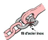
La manille doit toujours être d'une taille supérieure au diamètre de la chaîne (ex manille de 12 pour chaîne de 10).
