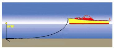
L'orin est une petite bouée frappée au moyen d'un bout à un orifice sur le diamant de l'ancre.
