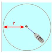
Au mouillage, un bateau n'est pas immobile. Sous l'action des vents ou du courant, il pourra décrire un cercle d'évitage dont le centre est l'ancre et le rayon (r), la ligne de mouillage plus la longueur du bateau.
