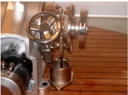
2. Selle la base del molinete con el sellante del silicon de la alta calidad Fijar el molinete en la cubierta usando pernos M10 in acero inoxidable (Excepto el Cayman 88 que tiene la junta y los pernos prisioneros de montaje incorporado)
