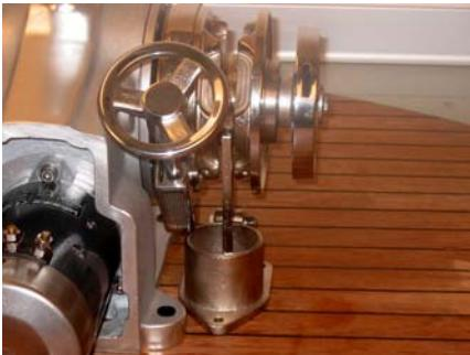
2. Sigillare la base del salpa-ancore con silicone e fissare il salpa-ancore al ponte usando viti e dadi M10 in acciaio inox. (Ad eccezione del modello Cayman 88 che ha la guarnizione e i prigionieri di fissaggio incorporati).
