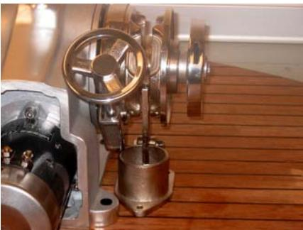
2. Scellez la base de guindeau avec le mastic de silicium et adaptez le guindeau sur le pont à l'aide des boulons et les écrous M10 en acier inoxydable (Excepté le modèle de Cayman 88 qui a la garniture et les écrous de fixation incorporés)
