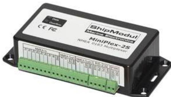
Cet équipement va donc recevoir les phrases NMEA de plusieurs équipements et, respectant leur intégrité, les concentrer sur une (ou plusieurs) sortie(s). Pour éviter un engorgement, la vitesse de transmission de données de la sortie doit être bien plus rapide que les entrées, idéalement la somme des vitesses des entrées.
