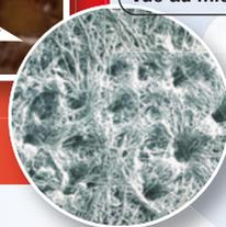
**2** • Certaines bactéries produisent un gaz, du sulfure d'hydrogène, qui est à l'origine de phénomènes de corrosion de l'acier constituant les cuves de stockage.
