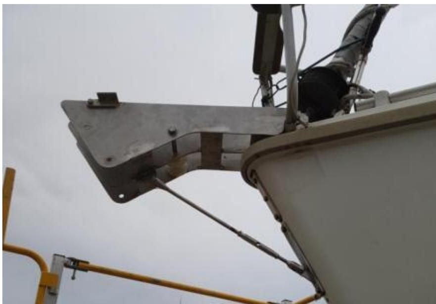
Charnière en place, il n'y a plus qu'à y rajouter des protections/fixations pour le teck (frottement potentiel de la verge sous le teck, 18 trous de fixations fraisés en sous face au diamètre des têtes de vis)
