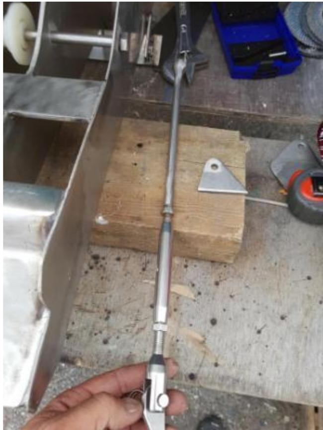
La fixation basse sera soudée sur la platine de fixation de la cadène de l'étau largable.
