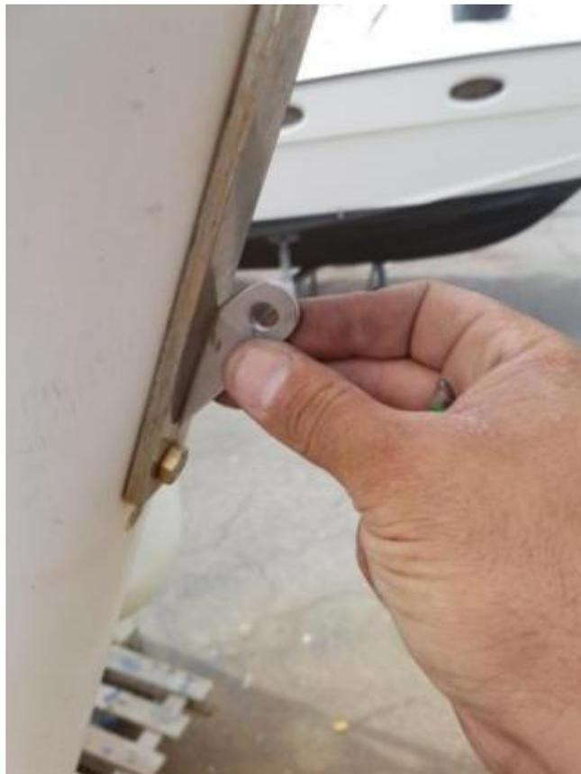
Bien protéger sa coque et avoir un jet d'eau à proximité. Faire une soudure rapide et refroidir de suite. Enlever le laitier, brosser le cordon, sécher le cordon et recommencer autant de fois que nécessaire... une galère !
