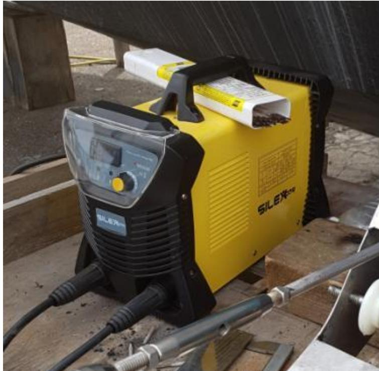
Les baguettes en ma possession sont bien évidemment en inox 316L, de 2.5mm de diamètre et de type OK 63.30 (pour onduleur). Le réglage d'intensité variera en fonction de l'épaisseur de la partie à souder.
