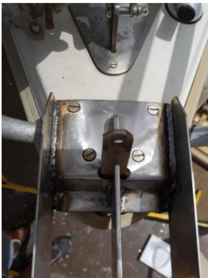
C'est soudé ! essai concluant pas de déformation. Vu que J'ai prévu d'installer une sous barbe, il faut donc en créer une. Ma solution a été de couper un ridoir et de l'allonger avec un rondin de 10mm de diamètre et de réaliser 2 platine de fixations.
