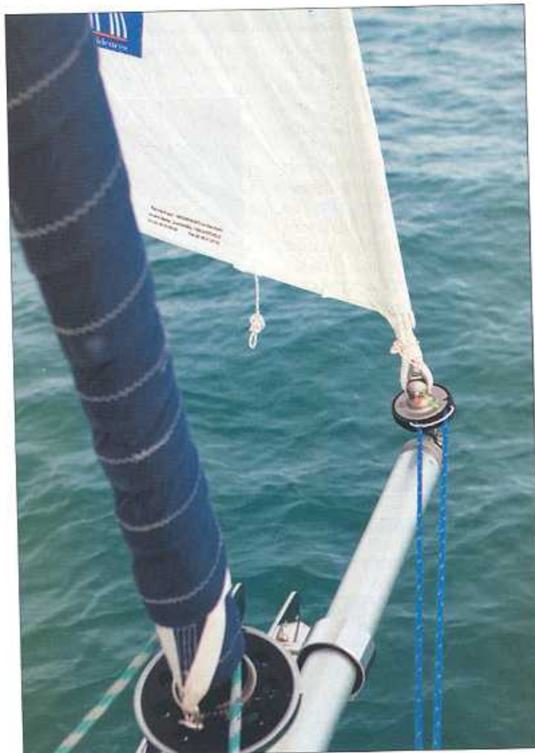
Bout-déhors. Monté sur un Océanis 40, chaque emmagasineur a été testé en situation en déroulant et en roulant un gennaker de 88 mètres carrés.
