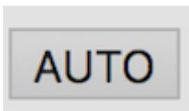
Le mode AUTO tente d'utiliser les top de mise en synchro et de démarrage / arrêt envoyés par les stations HFFAX pour se synchroniser correctement avec le signal de télécopie.
