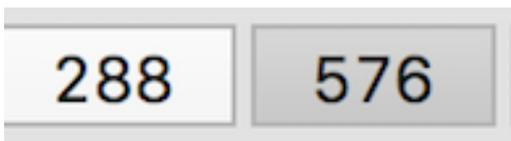
Le CIO (Index de coopération) doit être sélectionné. Pour HF FAX, c'est presque toujours 576, comme cela est également utilisé pour les satellites POES.
