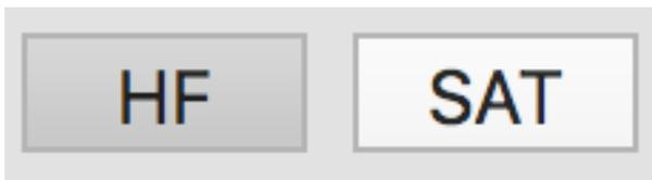
Deux boutons, appelés HF et SAT, sélectionnent le mode. HF est utilisé pour la radio météo sur radio HF (ondes courtes), SAT est utilisé pour décoder les transmissions APT des satellites météorologiques.
