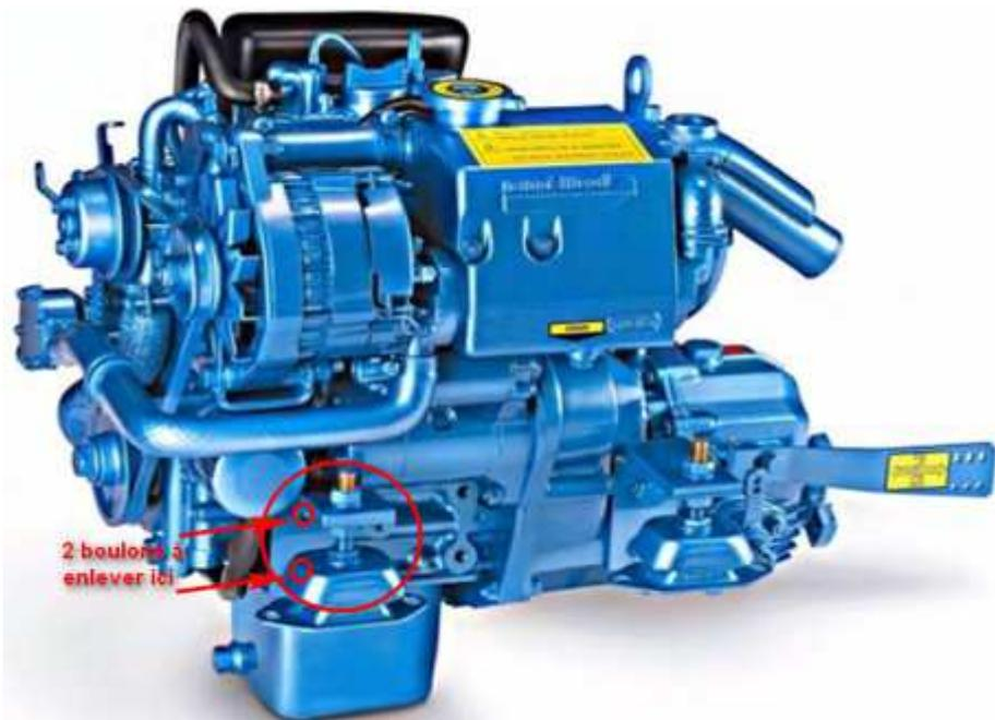
l'astuce de démonter la patte du support moteur a fonctionné... la mauvaise nouvelle c'est que le démarreur a plutôt une sale tête à l'intérieur (plein de rouille),
