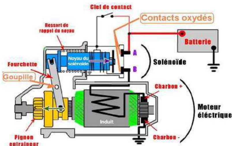
Avant d'acheter du neuf, il y a aussi la solution de porter le démarreur chez un ÉLECTRICIEN AUTO ....(surtout pas un garagiste !... ) LUI , en plus d'une bonne révision du démarreur (roulements, induit et charbons), il aura sans doute la solution pour une réparation de la bête à moindre frais... autre qu'un neuf ou un échange standard, et ça repart pour un bon moment à bien moins cher
