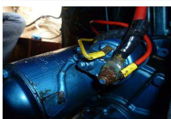
En principe ce démarreur se démonte en entier par les 2 boulons de 13 (1 sous le démarreur et 1 dessus) ;
