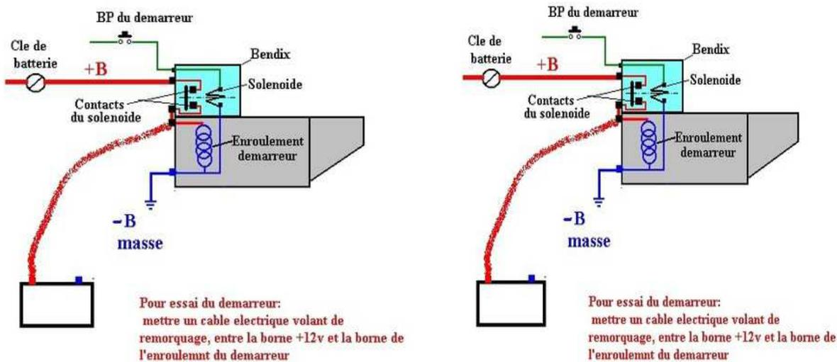
Le problème c'est le démontage car le boîtier du solénoïde est généralement serti, dessouder et ressouder les câbles internes nécessitent un gros fer à souder et savoir souder à l'étain.
