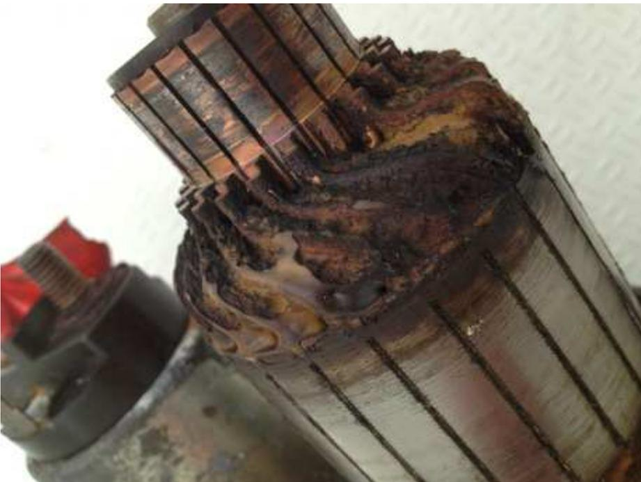
sur la photo du rotor, on semble deviner une traînée noire bien inquiétante qui "pourrait" être un amorçage ? Autour du rotor, as tu senti une odeur de vernis brûlé bien caractéristique?
