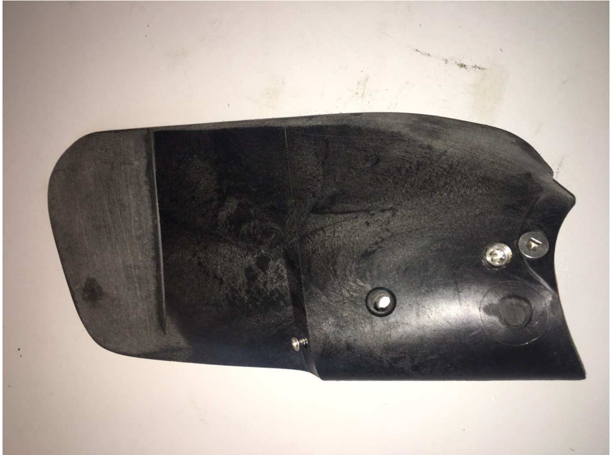
Pale neuve équipée d'une vis renfort d'appui
