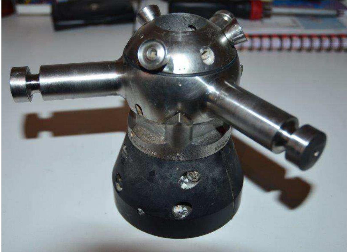
Alignement des 4 repères marqués au pointeau
