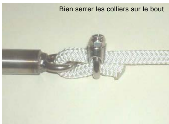
Raccordement du bout à la turbine Fig. 5
