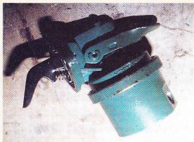
doit être démonté et nettoyé tous les ans. Les diaphragme et
