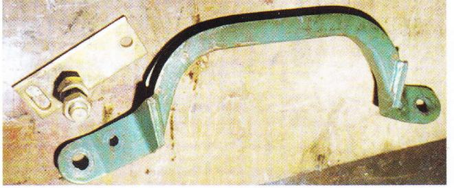
Ils doivent être contrôlés régulièrement. On doit pouvoir glisser l'extrémité du petit doigt dans l'espace compris entre la partie métallique et le caoutchouc. Si vous constatez une trace de
