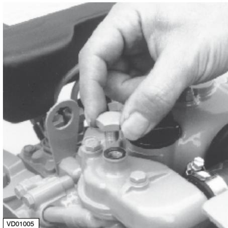
Le niveau du liquide de refroidissement doit être à 1 cm. environ de la partie inférieure de l'ouverture du remplissage.
