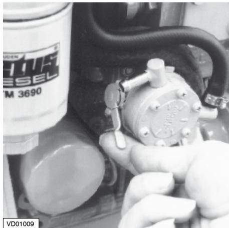
Une deuxième douille de prise d'air se trouve sur la pompe à carburant.
