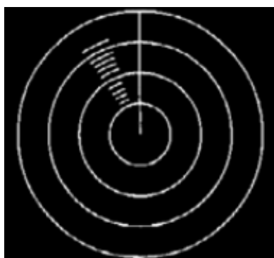
Réponse d'un transpondeur radar SART à une distance de 2 à 3 milles
