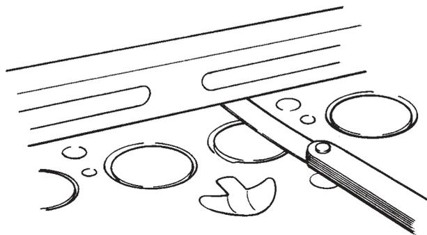
Fig. 15. Contrôle de la planéité de la culasse
