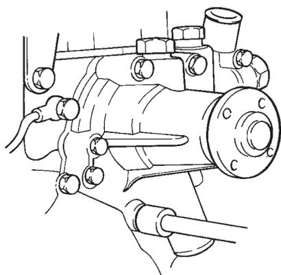
Fig. 11. Dépose de la pompe de circulation
