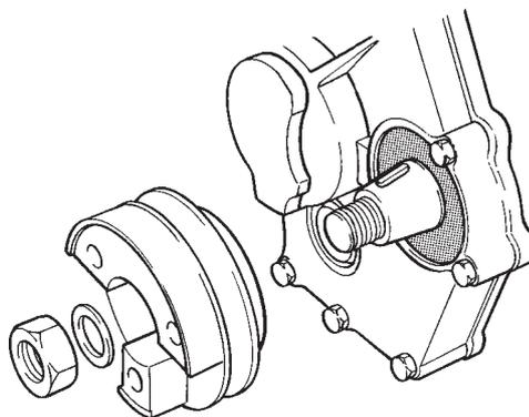
Fig. 56 Dépose de la poulie de vilebrequin
