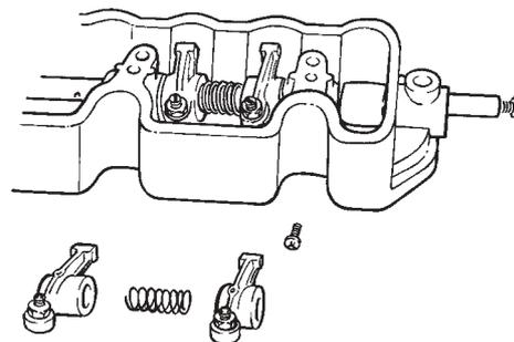
Fig. 25. Dépose du mécanisme de culbuteur (MD2040)
