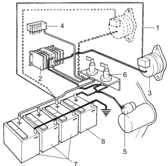
Fig. 112 Branchement du système de capteur à l'alternateur standard, principe
