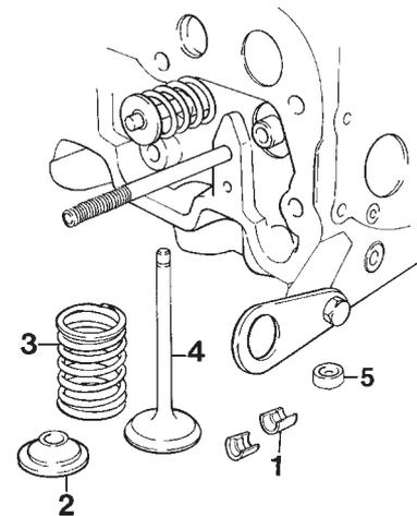
Fig. 29. Pose des soupapes
