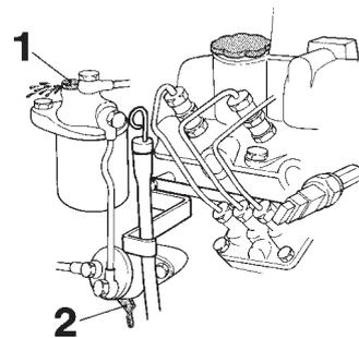
2. Ouvrir la vis de purge (1) sur le couvercle du filtre à carburant et, avec la pompe d'amorçage (2), pomper pour que le carburant arrive sans bulles d'air. Serrer la vis pendant que le carburant s'écoule.
