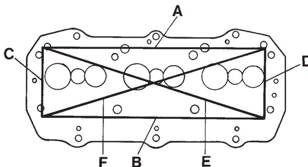
Fig. 16. Contrôle de la planéité de la culasse
