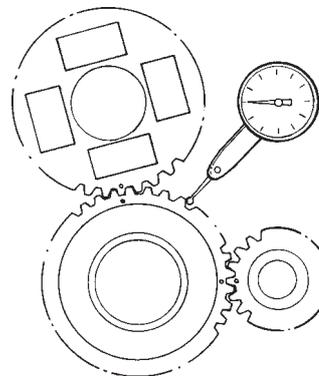
Fig. 60 Contrôle du jeu en flanc de denture
