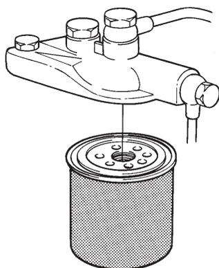
2. Dévisser et enlever le filtre usagé, le jeter. Si nécessaire, utiliser une clé spéciale pour la dépose.
