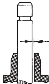
Fig. 22. Jeu, soupape – guide de soupape (culasse)
