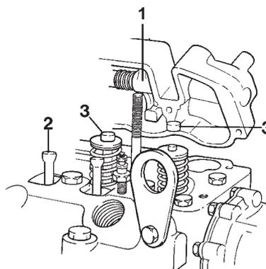
Fig. 32. Pose du mécanisme de culbuteur (MD2040)
