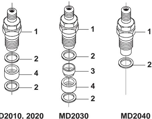
Fig. 10. Dépose d'injecteur
