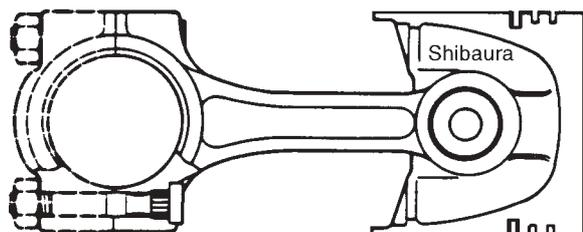
Fig. 50 Assemblage de piston et bielle (MD2030, MD2040)
