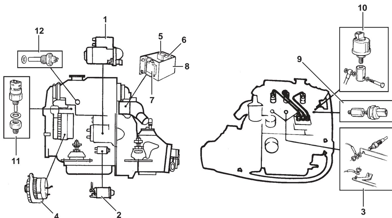
Fig. 111 Emplacement des composants électriques sur le moteur
