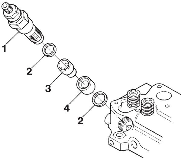
Fig.102 Dépose d'injecteur
