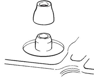
Fig. 28. Pose des joints de queue de soupape
