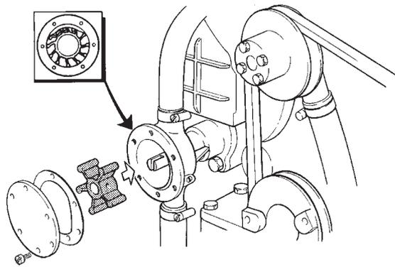
Fig. 109 Remplacement de la roue de pompe
