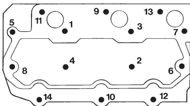
Fig. 31. Schéma de serrage, MD2020, MD2030, MD2040
